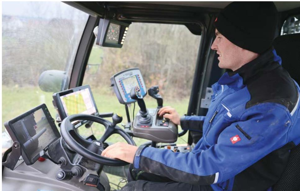
High-Tech bei der Gülleausbringung: Über verschiedene Monitore können zahlreiche Funktionen überwacht und präzise im Exaktversuch gesteuert werden.
