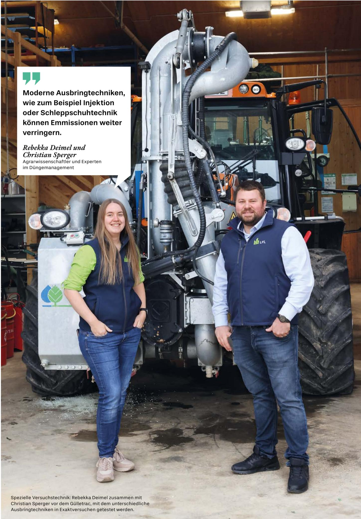
Spezielle Versuchstechnik: Rebeka Deimel zusammen mit Christian Sperger vor dem Gülletrac, mit dem unterschiedliche Ausbringtechniken in Exaktversuchen getestet werden.
