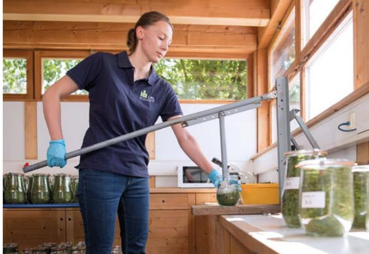
Befüllung des 1-Liter-Laborsilos zur Bestimmung der Gärgeschwindigkeit
