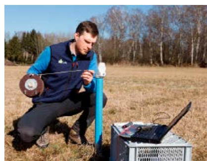
Messung des Grundwasserflurabstands – Moorbodenschutz beginnt bei Grundwasserflurabständen von weniger als 30 Zentimetern.
