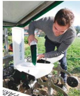
Modernste Agrartechnik: Der Rübenroboter kann über Tablet gesteuert und mit Rübensamen befüllt werden, Handsensoren messen den Nährstoffbedarf der Pflanzen (rechts).
