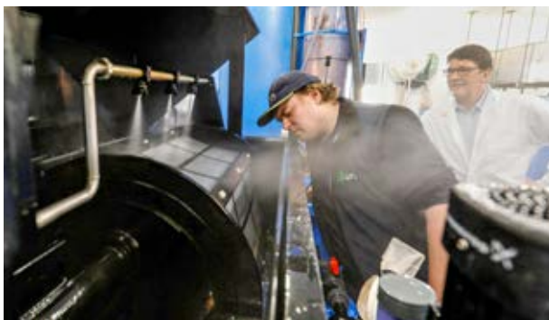
Wassersparend: Moderne MikrosiebfILTER reinigen rückstandlos und ermöglichen geschlossene Kreisläufe
