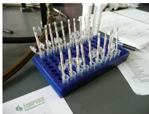
„ImmunoStrip® Test“ zum schnellen Nachweis von Clavibacter michiganensis subsp. sepedonicus und Ralstonia solanacearum an Kartoffeln
