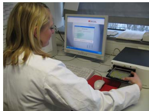
Messen einer ELISA-Platte am PC-gesteuerten Photometer
