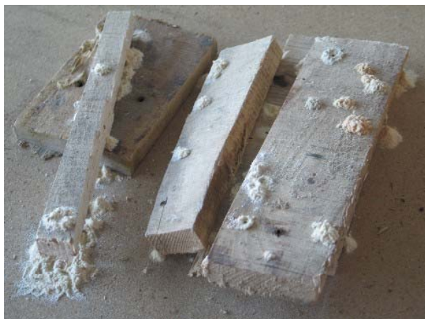
Verpackungsholz aus Indien mit austretendem feinen Bohrmehl
