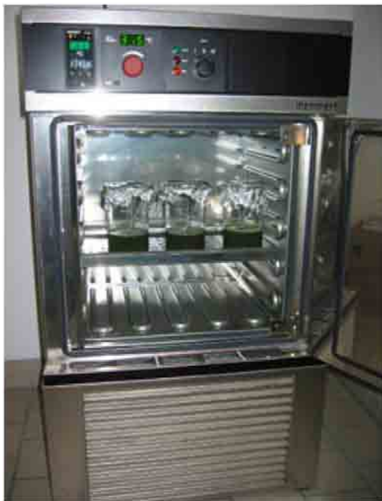
Abb. 3: Brutschrank mit 24 Plätzen für Bechergläser
