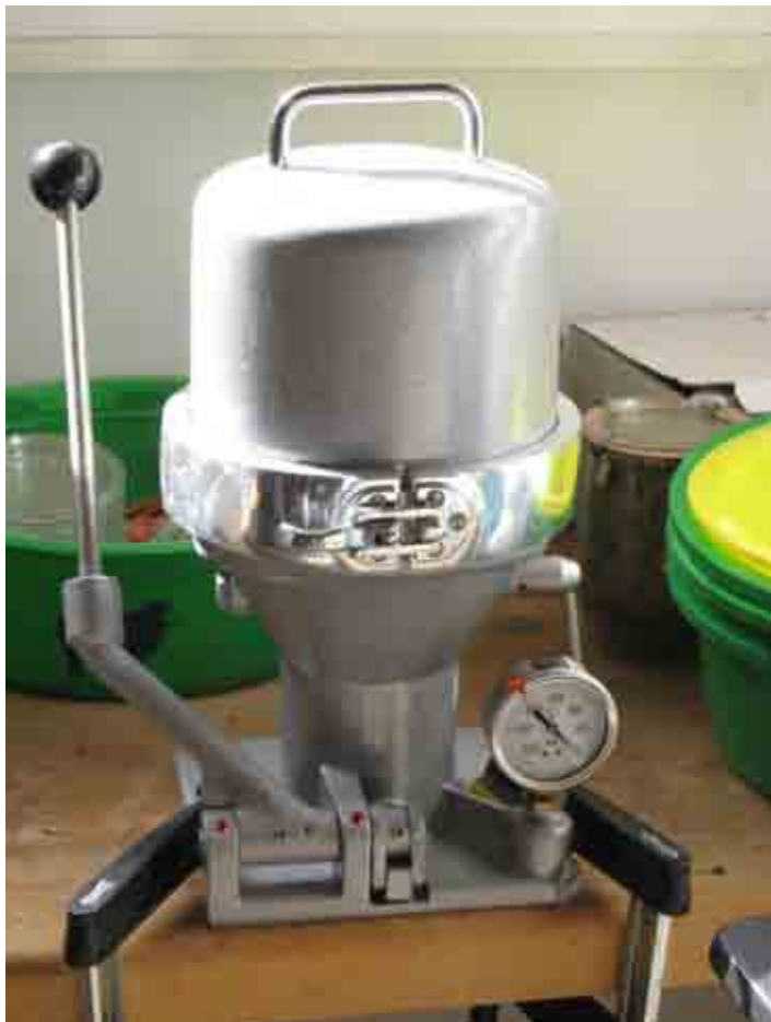
Abb. 2: Tinkturenpresse zur Pflanzensaftgewinnung
