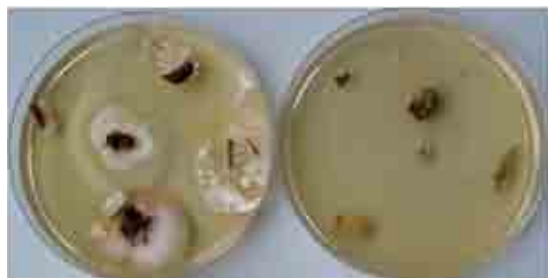
Abb. 17: Proben aus einer Silage auf Nähragar: starke Verpilzung bei Sauerstoffzufuhr (links) bzw. keine Verpilzung bei Sauerstoffausschluss (rechts) während der Silierung
