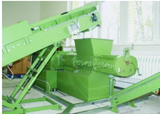
Abb. 5 Allmetallerkennungsanlage
