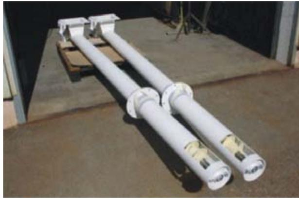
Abb. 4: Rohrschneckenförderer
