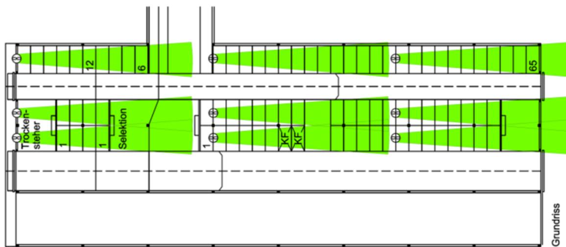
Abb. 2: Anordnung von Ventilatoren über dem Liegebereich der Tiere
