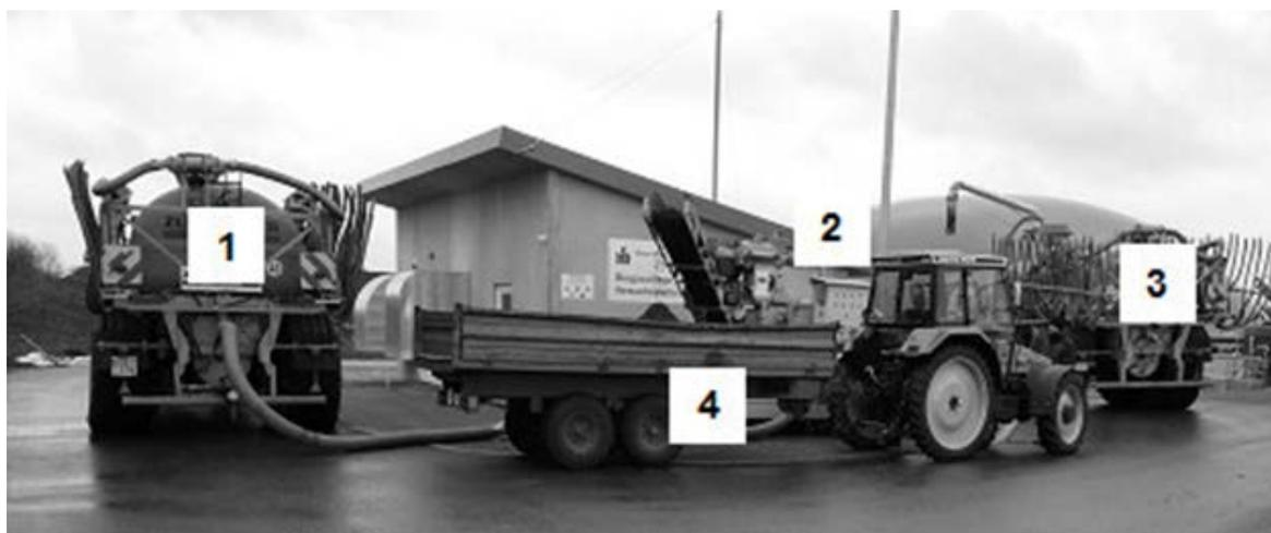
Abb. 2: Versuchsaufbau zur Massenbilanzierung sowie zur Erfassung der Verfahrenskennwerte bei der Wirtschaftsdüngerbereitung mit einem Pressschneckenseparator
