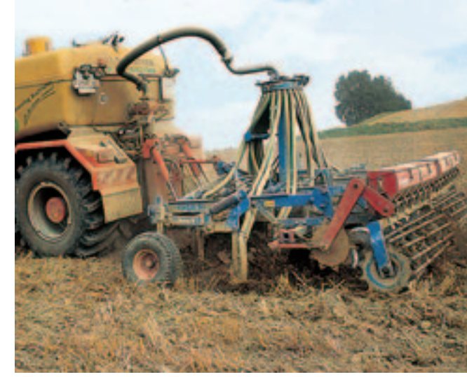
Moderne Gülleselbstfahrer kombinieren Gülledüngung, Krumbearbeitung und Zwischenfruchtsaat.
