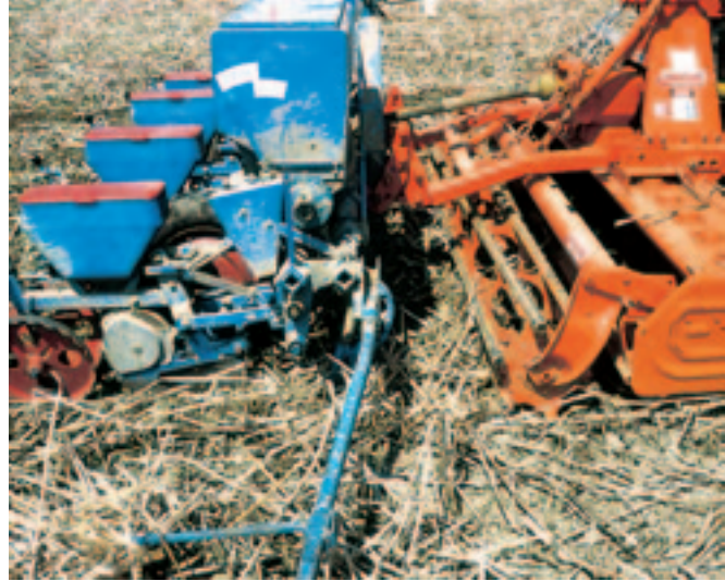
Für die Mulchsaat hat sich die Kombination Kreiselege und Einzelkornsäegerät bewährt.
