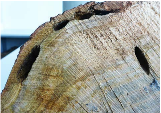
Abb. 5: Bohrgänge im Holz
