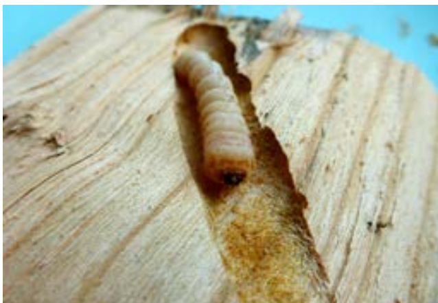
Abb. 1: Bohrgänge im Holz
