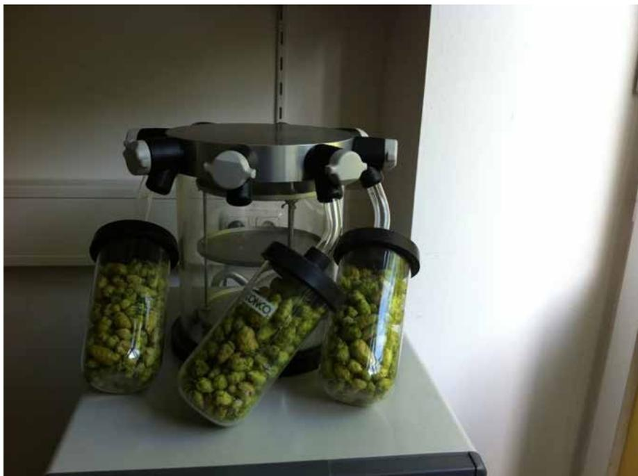
*Abb. 43: Gefriertrocknung der Analysenproben im Labor*
