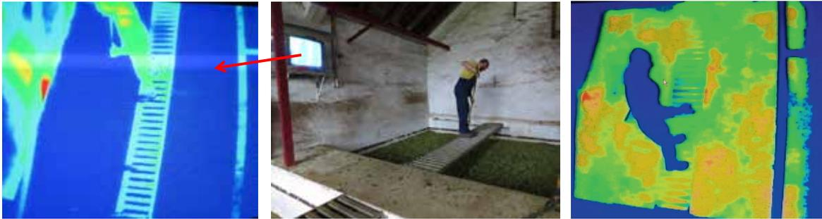
Abb. 54: Kontrolle auf gleichmäßige Schüttdichte nach dem Befüllen der Aufschütthorde und auf Gleichmäßigkeit während der Trocknung (Bilder: Selmeier G., 2016)
