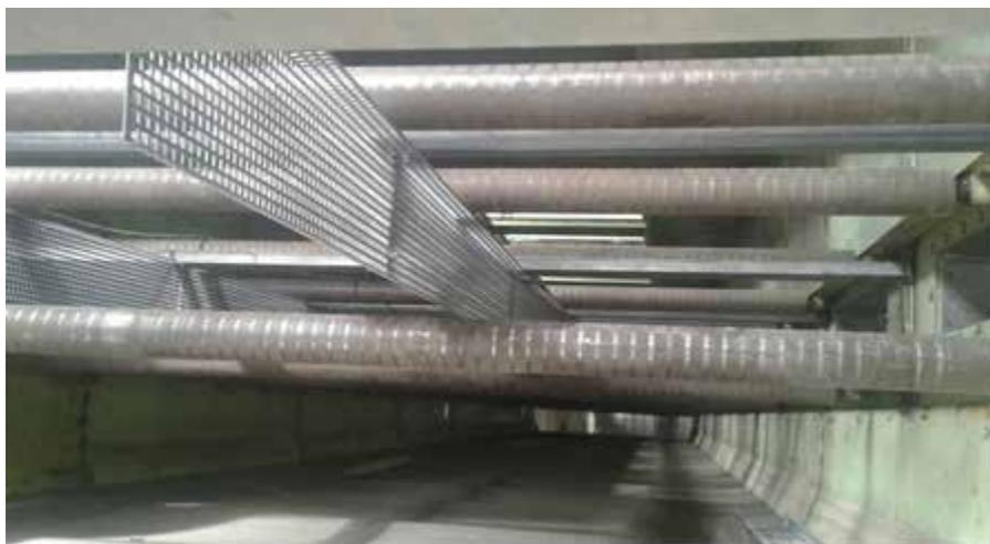
Abb. 14: Eingebaute Diffusorbleche in den Bandzwischenräumen eines Bandtrockners tschechischer Bauart
