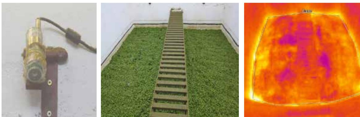
Abb. 53: Wärmebildkamera, Messfläche über der Aufschütthorde, zugehöriges Wärmebild (Bilder Hofer H., 2019)
