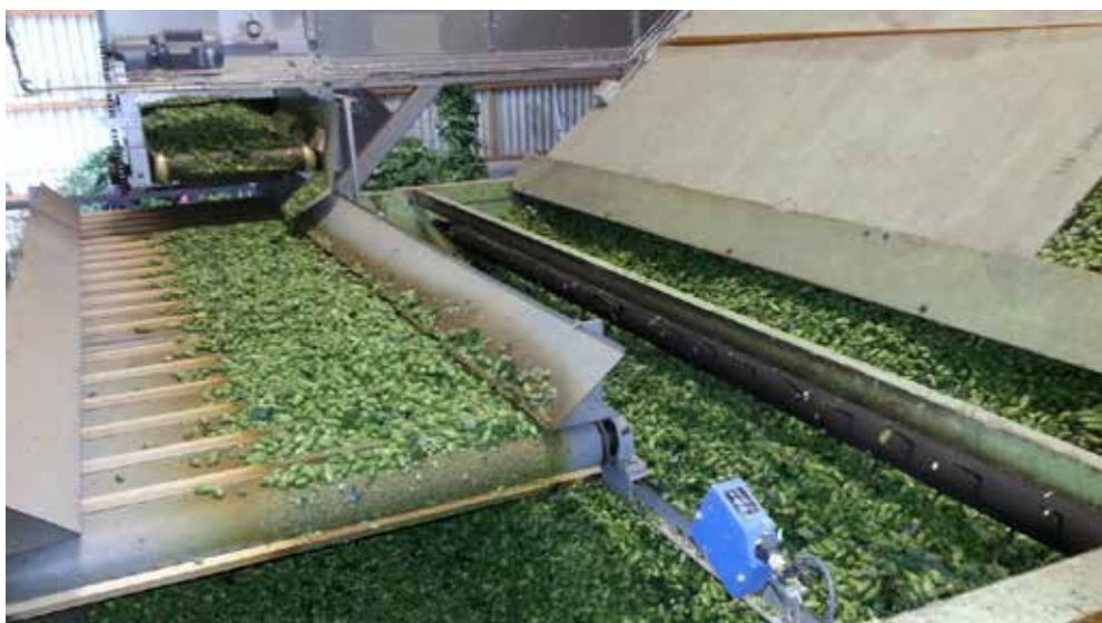
Abb. 63: Schichtweise Beladung des Auftragbandes mit einem Befüllband
