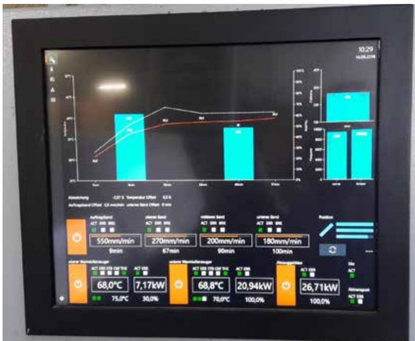
Abb. 67: Anzeige relevanter Einstellungen und Messwerte bei der Bandtrocknersteuerung
