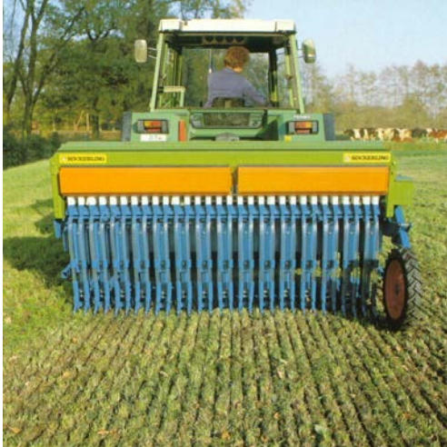
Abb. 3: Durchsaat in lebende verfilzte Bestände ist technisch möglich, aber falsch
