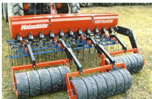
Abb. 6: Kombination Egge und Saattechnik und Walze erlauben sowohl kombinierte wie auch getrennte Arbeitsgänge
