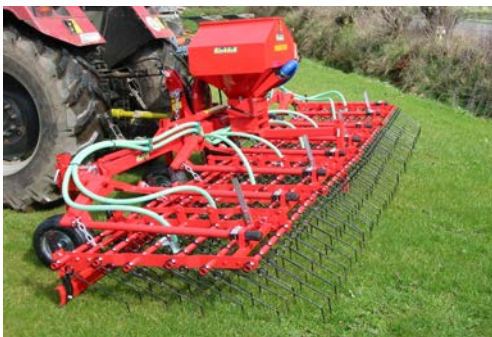
Abb. 5: Kombination von (Feder-) Zinkenegge und Saattechnik zur Übersaat
