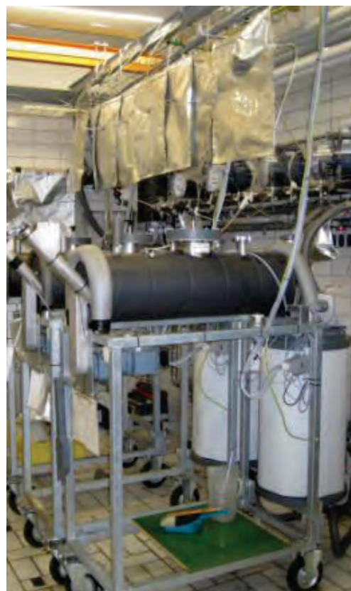
Abbildung 2: Anlagen-Beispiel für zweistufig betriebene Fermenter
