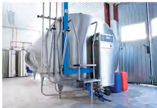
DeLaval Milchkühltank DXCEM mit Reinigungsautomat T250
