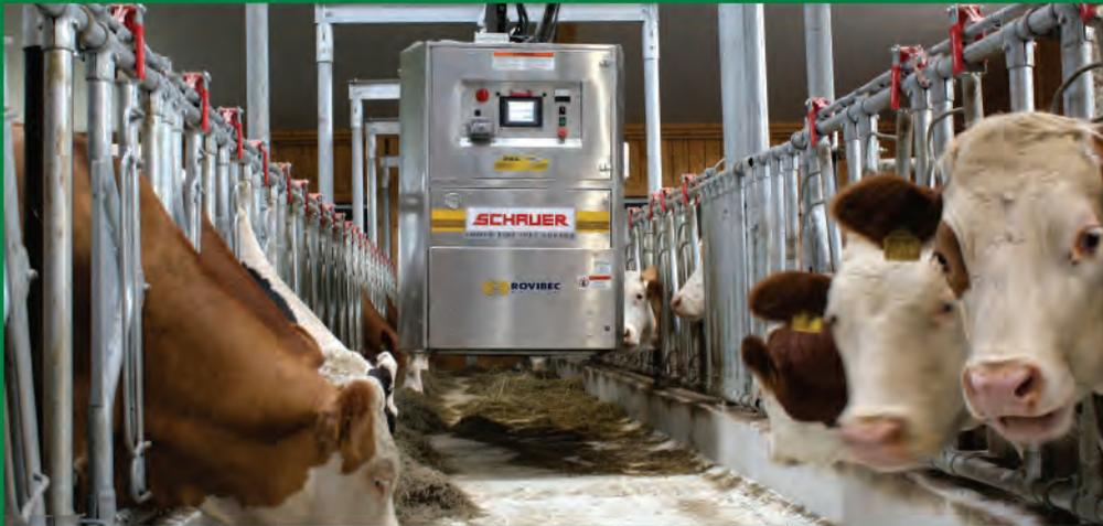
Die energiesparende, automatische Grundfüttervorlage für Rinder
