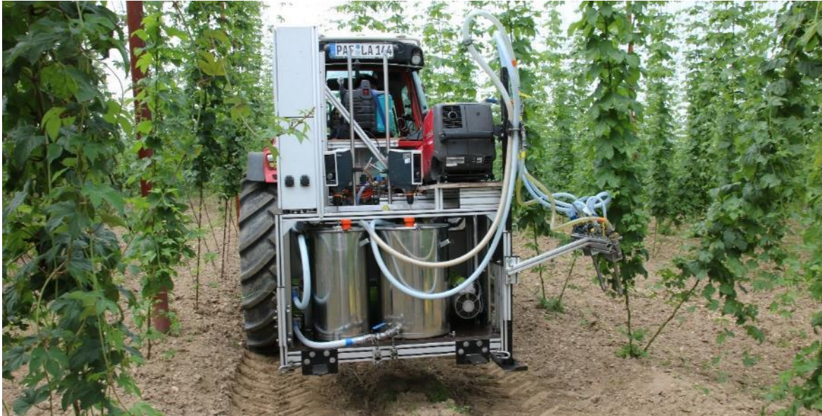
Abb. 27: Applikationsgerät „SAM“ (System für die Applikation des Mulchmaterials) ausgestattet mit je einem Tank pro Komponente, einem getrennten Leitungssystem und einem Mischerblock samt Statikmischer für die Applikation in der Reihe
