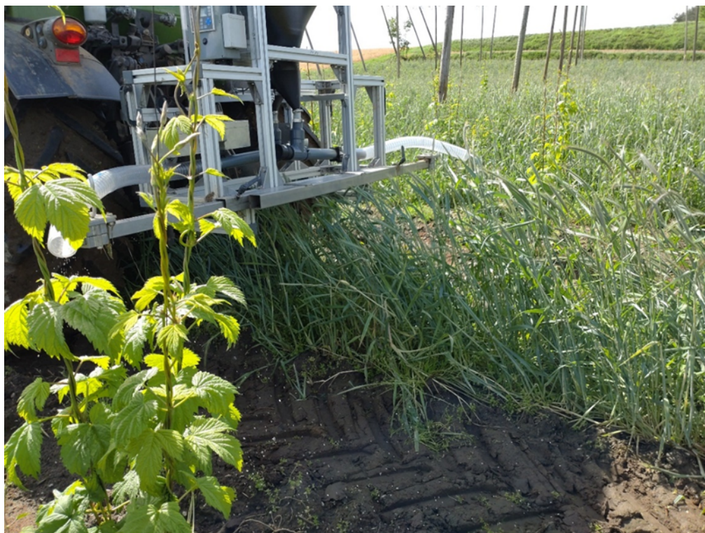
Abb. 77: Mit Sägemehl als Trägersubstanz werden die Raubmilben bei der technischen Applikation sanft an die jungen Hopfenreben geblasen
