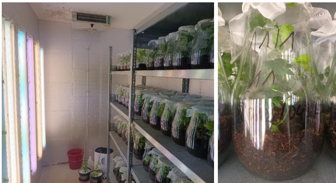
Abb. 41: Mikrogewächshäuser des Blattlaustests in der Klimakammer & Entwicklung der Pflanzen in einem Mikrogewächshaus nach 18 Tagen
