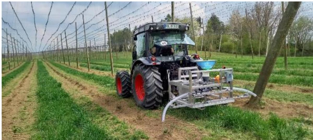
Abb. 8.4: Modifizierte Konstruktion der Fa. Koppert im Jahr 2022 zur frühen, bodennahen technischen Ausbringung von Raubmilben im Hopfenbestand; Dürnwind. 02.05.2022
