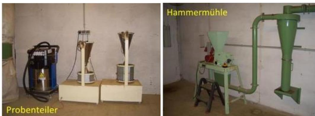
Abb. 7.15: Hammermühle und Probenteiler
