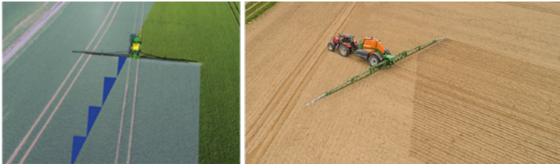
Abbildung 23: Minimierung von Fehlbehandlungen durch automatisierte Teilbreiten- (links) und Einzeldüsenschaltung (rechts), (Bilder: John Deere, Amazonen-Werke H. Dreyer SE & Co KG)
