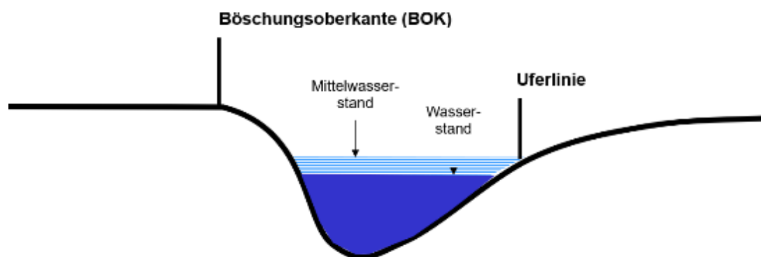
Abbildung 72: Schematische Darstellung von Böschungsoberkante, Mittelwasserstand und Uferlinie (StMELF, 2023)
