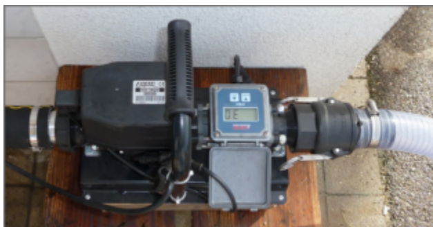
Abbildung 12: Füllsysteme mit Durchflussmesser und automatischer Abschaltung verhindern, dass zu viel Spritzbrühe angesetzt wird und Geräte bei der Befüllung überlaufen (Bild: W. Heller)
