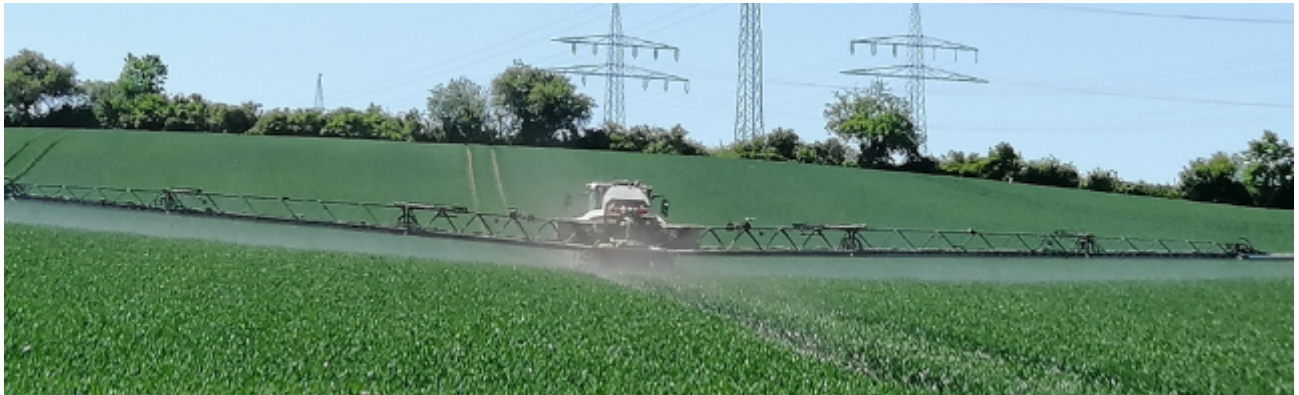
Abbildung 20: Sensoren halten das Gestänge exakt über der Zielfläche (Bild: W. Heller)
