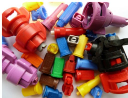
Abbildung 14: Düsen gibt es in unterschiedlichen Größen und Bauformen. Die richtige Auswahl und der jeweils passende Spritzdruck entscheidet über den Erfolg einer Pflanzenschutzmaßnahme (Bild: W. Heller)
