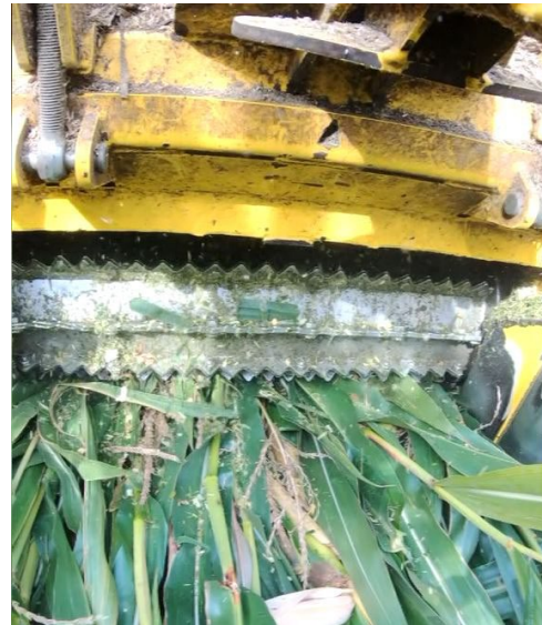
Abbildung 4: Vorpresswalzen im Einzug des selbstfahrenden Feldhäckers (Quelle: Stefanie Wehry)
