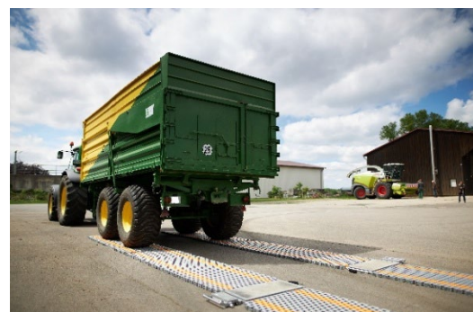
Abbildung 3: Dynamische Achslastwaagen mit Ausgleichsmatten zur Ermittlung der Frischmasse (Quelle: Christiane Pietsch)
