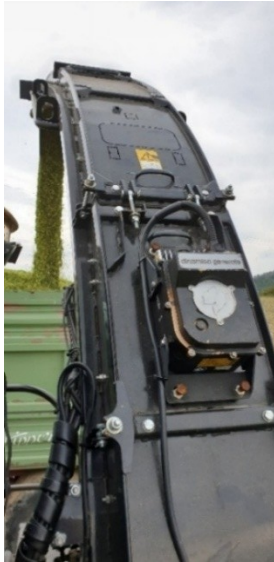
Abbildung 3: Nahinfrarotspektroskopie-sensor am Auswurfkrümmer eines selbstfahrenden Feldhäckers (Quelle: Franz Worek)
