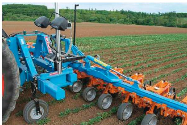
Abbildung 24: Hackgerät mit sensorgesteuerten Verschieberahmen [Quelle: Maschinenfabrik Schmotzer GmbH]
