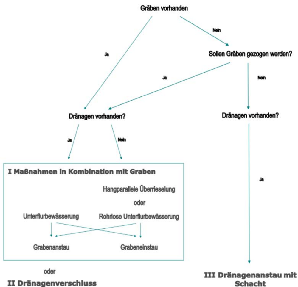
Abbildung 1: Auswahl geeigneter Maßnahmen in Abhängigkeit von den vorhandenen Entwässerungseinrichtungen. Gräben können durch Stauwehre oder -dämme verschlossen werden. In Kombination mit einer (rohrlosen) Unterflurbewässerung oder einer hangparallelen Überrieselung kann die Effektivität dieser Maßnahmen erhöht werden. Dränagen können an ihrer Mündung in den Gräben durch einen Aufsatz oder, falls der Anstau auf der Fläche erfolgen soll, durch einen Schacht angestaut werden [verändert nach (Lfl 2024)].
