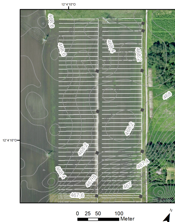
Abbildung 16: Auswahl einer geeigneten Maßnahme für die Fläche 2. Aufgrund der Hangneigung wurden alle 30 bis 40 cm Höhendifferenz an Knotenpunkten (weiß, Entwässerungssystem), an denen früher Sedimentschächte verbaut waren, Anstauschächte (schwarze Quadrate) eingebaut. So ist es theoretisch möglich die einzelnen Teilflächen auf Zielwasserstand anzustauen.
