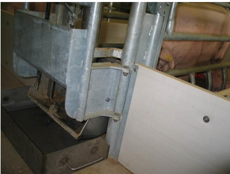
Abb. 4: Kipptrog zur Ermittlung der Futterreste im Abferkelabteil für Fütterungsversuche
