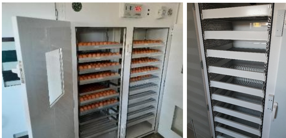
Abbildung 13: Brutautomat (links) und Schlupfbrüter (rechts) vor Umlage der Bruteier im 2. Durchgang
