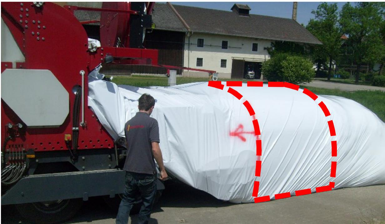
Abbildung 1: Pressvorgang beim Folientunnel, rot markiert der Bereich des Metalltunnels
