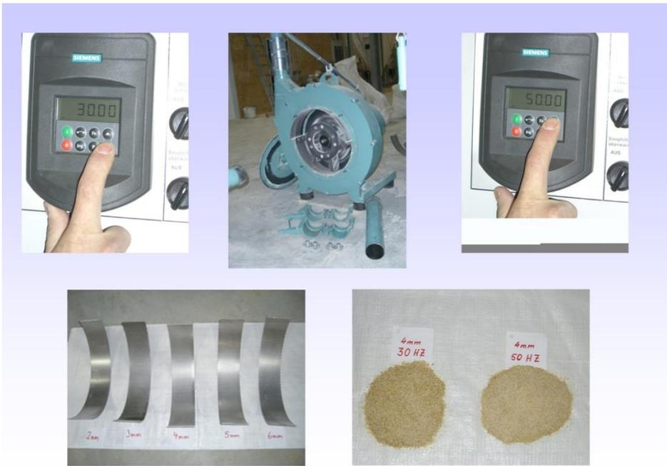
Abbildung 1: Hammermühle in Schwarzenau (11 kW) mit Wechselsieben und Frequenzumrichter
