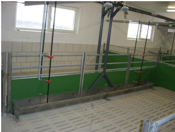
Abb. 4: Wellnessflüssigfütterung mit Langtrog und Futersensor
