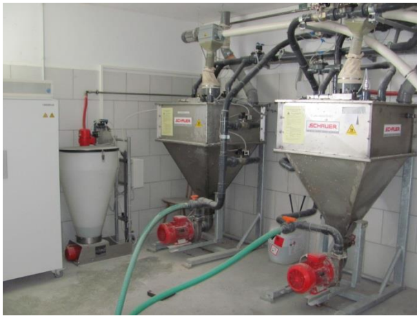
Abb. 1: Flüssigfutterbehälter mit Kleinmengendosierer (links)
