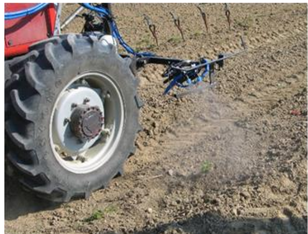
Sensorgesteuerte Flachstrahldüsen zur Reihenbehandlung
