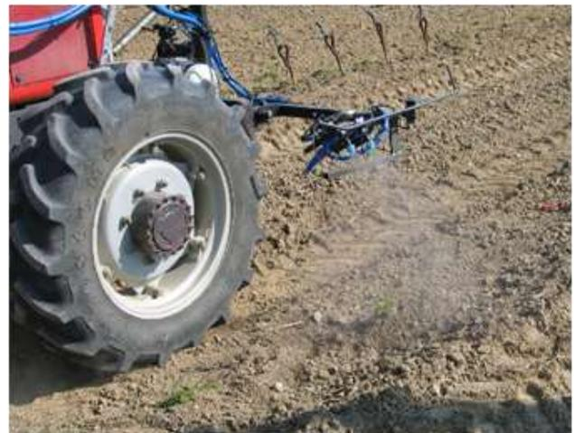
Abb.: Sensorgesteuerte Flachstrahldüsen zur Reihenbehandlung
