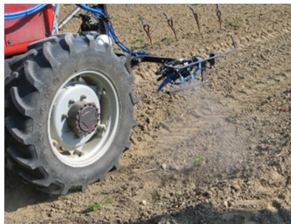
Abb.: Sensorgesteuerte Flachstrahldüsen zur Reihenbehandlung
