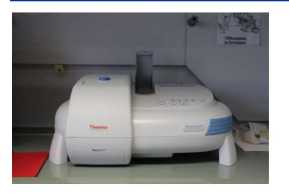
Messung der Absorption A bei den Wellenlängen A<sub>275</sub>, A<sub>325</sub>, A<sub>355</sub>
