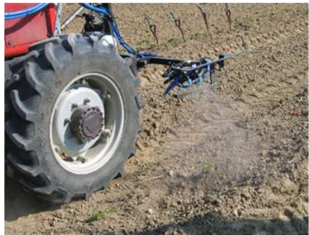
Sensorgesteuerte Flachstrahldüsen zur Reihenbehandlung
