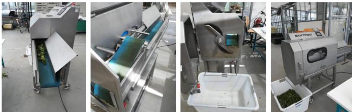
*Abb. 6: Schneiden der Pflanzenproben in der Bandschneidemaschine mit Förderband*
