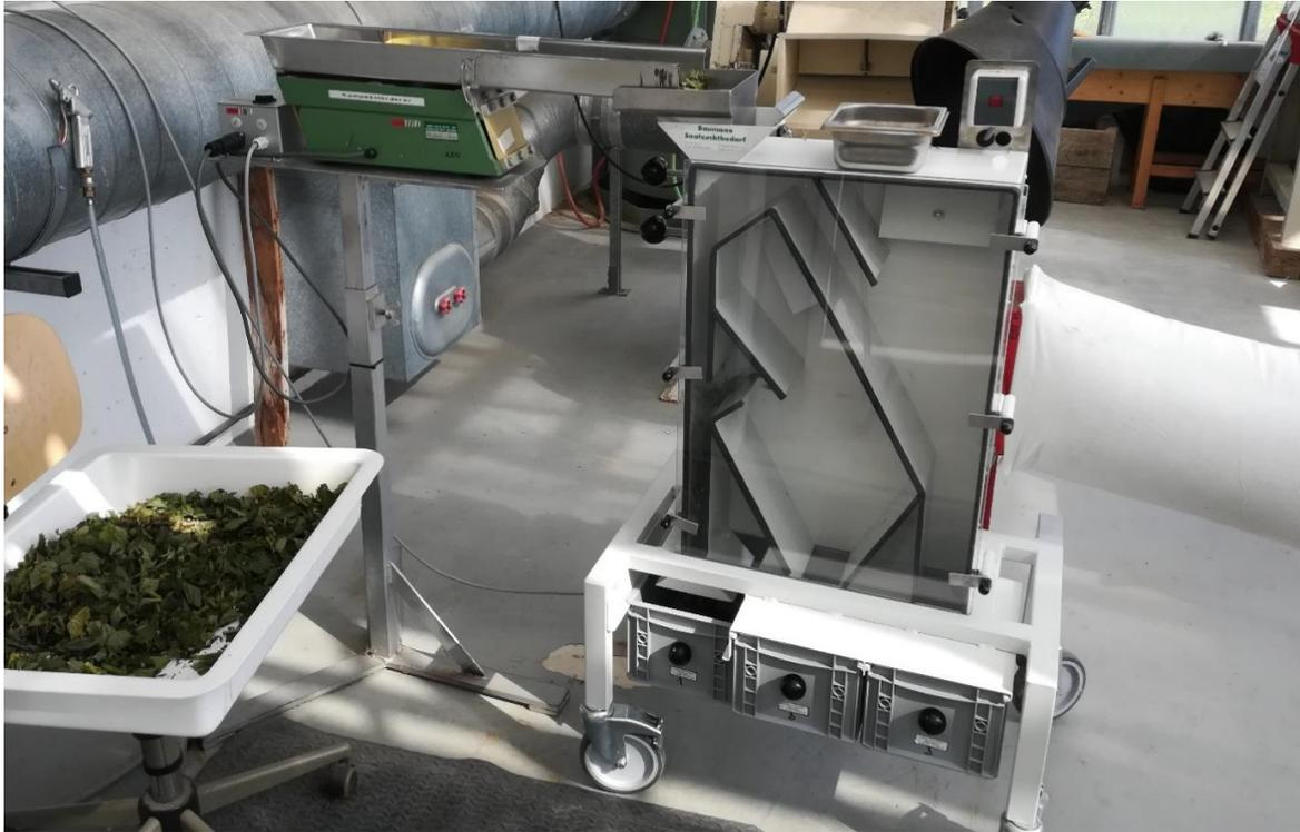
*Abb. 7: Separieren von Blättern und Stängeln mit dem Saugluft-Stufensichters und vorge-schaltetem Kompaktförderer mit Schüttelrinne*
