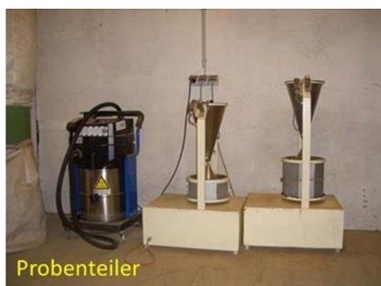
Abb. 59: Hammermühle und Probenteiler
