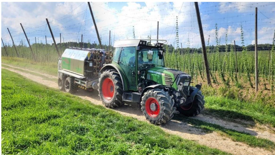
Abb. 26: Mehrkammernversuchsspritze der Amtlichen Mittelprüfung
