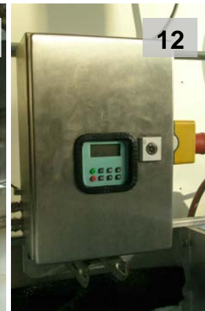
Abb. 10–12: Details der verstärkten und verstellbaren Motoraufhängung (10), Kraftübertragung zur Siebtrommel (11) und Drehzahlsteuerung (12)
