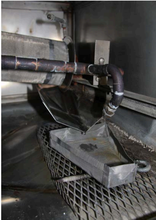
Abb. 4: Detail der Wasserführung in einem amerikanischen "Egg-Extraktor" (J. Spencer, Illionois; persönl. Mitteilung)
