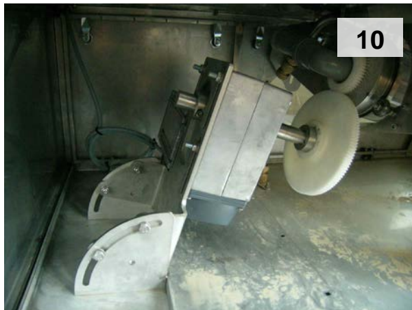
Abb. 10–12: Details der verstärkten und verstellbaren Motoraufhängung (10), Kraftübertragung zur Siebtrommel (11) und Drehzahlsteuerung (12)
