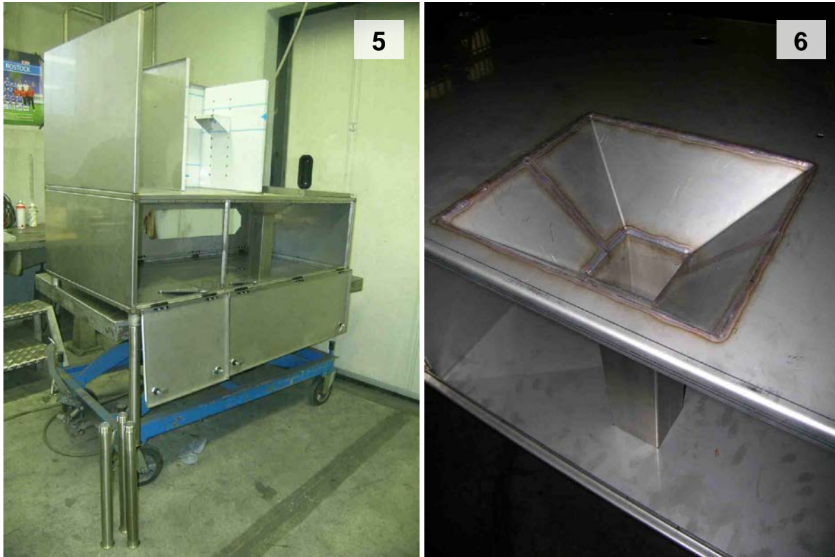
Abb. 5–6: Fertigungsstand der Ei-Waschanlage November 2009, Korpus (5), Durchflusstrichter (6)
