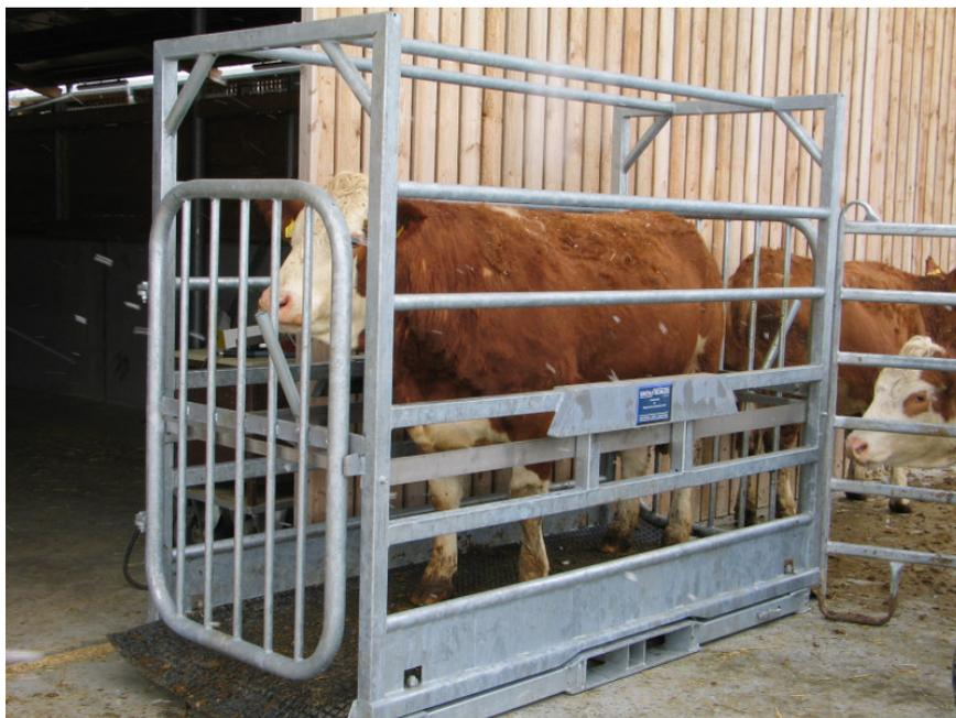
Abb. 14: Waage mit automatisierter Tiererkennung
