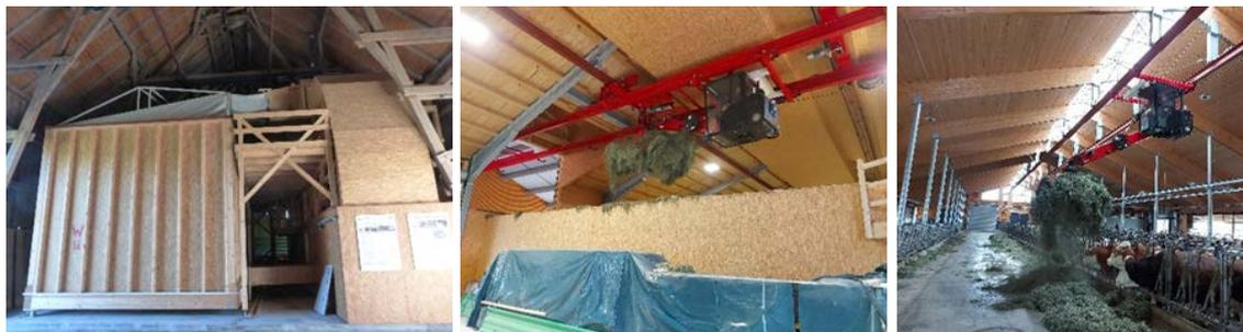
*Heubelüftungsversuchsanlage (HBVA) in Hübschenried (links), Heukran mit Querschnitt bei der Heuentnahme aus den Belüftungsboxen (Mitte) und Heuvorlage direkt am Futtertisch (rechts)*
