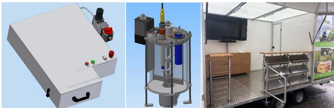
*Pneumatische Hochdruckpresse für Kartoffelproben (links), Fermenter zur Analyse von Restgasen (Mitte), Inneneinrichtung des LfL-Ausstellungsanhängers (rechts)*
