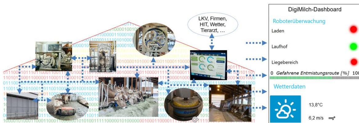
*Schematische Darstellung von Vernetzung der Stalltechnik und Überblick über die ausgewählte Stalltechnik auf dem Entwurf des DigiMilch-Dashboards.*
