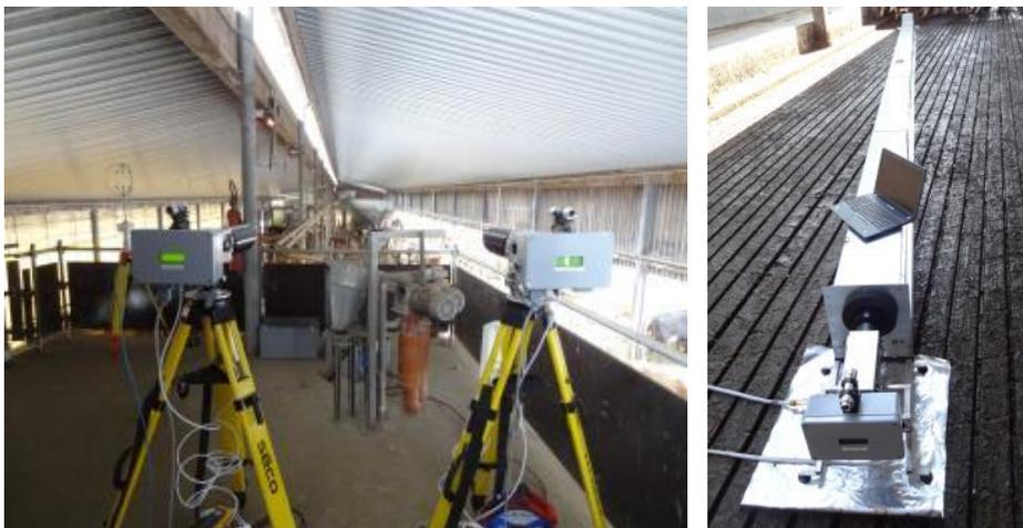
*$\text{NH}_3$ - und  $\text{CO}_2$ -Diodenlaser-Spektrometer während der Messung in einem Milchviehstall (links); Messtunnel bei der Laufhofmessung (rechts)*
