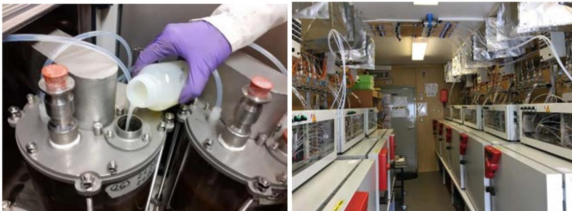
*Prüfung von Güllezusatzstoffen (links) in der neu entwickelten Versuchsanlage (rechts)*
