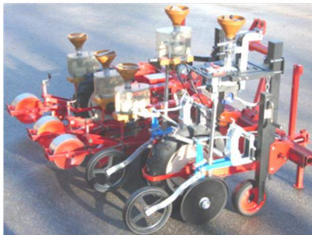
*Digitaler Prototyp des Säaggregats (links); Die herkömmliche Technik, Prototypen des Präzisionssäaggregats aus 2012 (mechanisch angetrieben) und 2013 (elektrisch angetrieben) (Bild rechts)*
