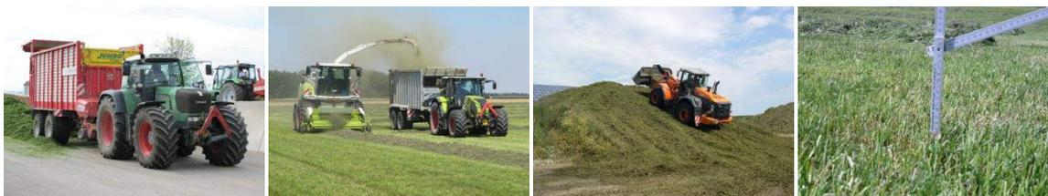
*Ladewagenkette, Häckselkette, Radlader beim Verdichten im Silo und Bestimmung der Schnitthöhe im Dauergrünland (v.l.n.r.)*
