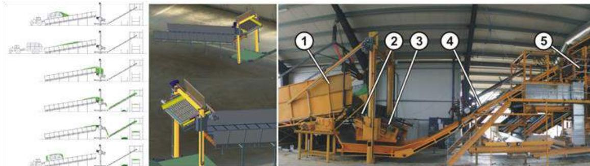
*Konzept der automatischen Beschickung der Hopfenpflückmaschine (links); Virtueller Prototyp der Vorrichtung für die automatische Beschickung (mitte); erster Prototyp der Vorrichtung für die automatische Beschickung angekoppelt an die Pflückmaschine (rechts)*
