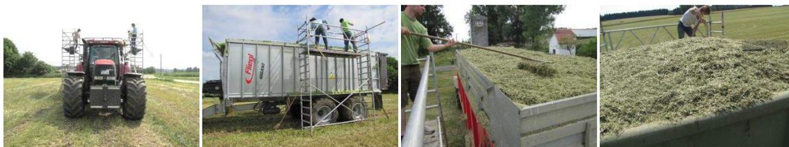
*Bestimmung der Häckselgutdichte am frisch beladenen Fahrzeug direkt am Feld
