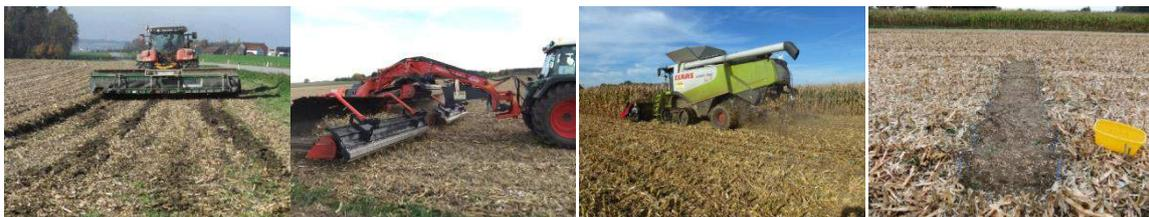
*Erntetechniken zur Maisstrohbergung (von links nach rechts: Schwadhäcksler von BioG, Bandschwader von Kuhn, Strohsammler von Geringhoff) und Bestimmung der Erntereste (rechtes Bild)*
