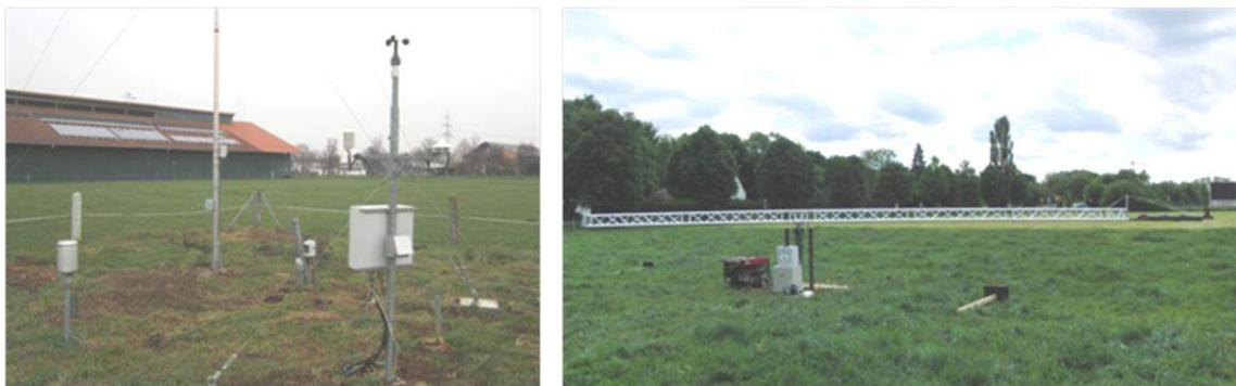
*Wetterstation am High-Tech-Stall in Grub (links), Prüfstand zum Test von GPS-GSM Ortungssystemen (rechts)*
