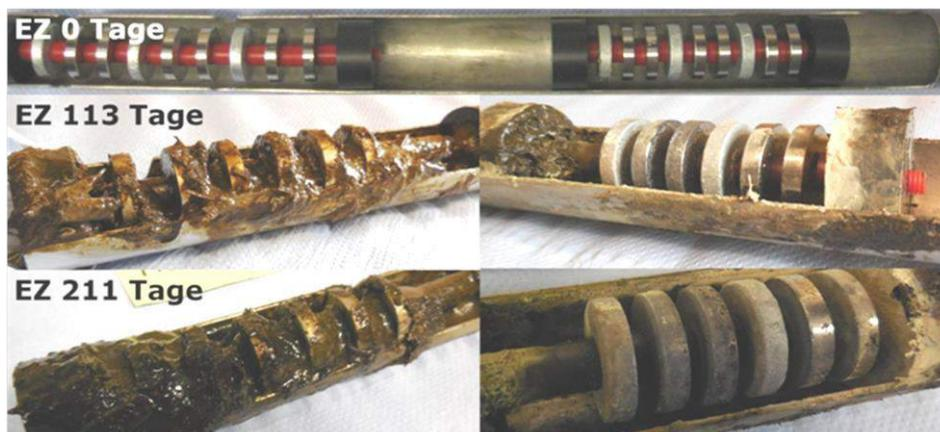
*Rondensegment für die Exposition in der Flüssigphase (links) und Rondensegment für die Exposition in der Gasphase (rechts) nach unterschiedlichen Expositionszeiten (EZ)*
