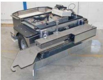
*Prototyp des Entmistungsroboters*
