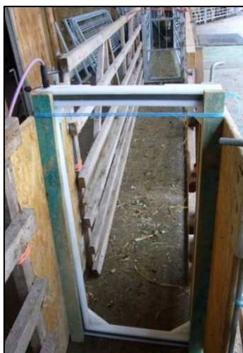
Abb. 4: Durchlaufantenne im Treibgang
