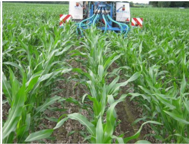
Ausbringung in Bestand mit Scheibenschlitzgerät
