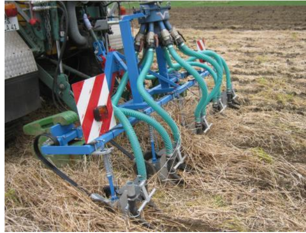
Mulchsaat ohne Saatbettbereitung (Gülle mit Schlitzgerät)
