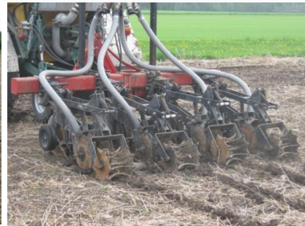
Streifenbodenbearbeitung mit Gülleinjektion in Streifen
