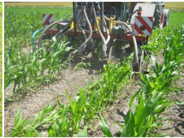
Ausbringung in Bestand mit Scheibeninjektor
