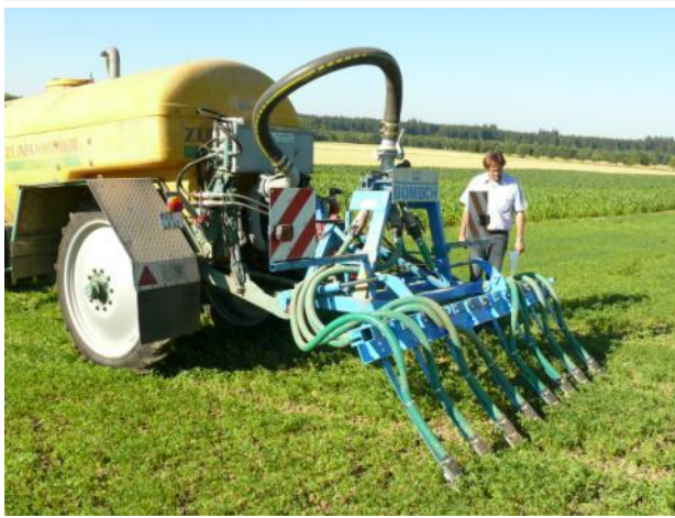
Ausbringung in Bestand Schleppschuh
