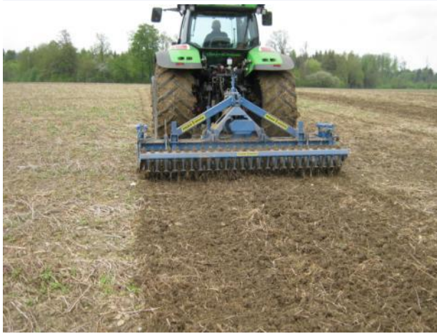
Mulchsaat mit Saatbettbereitung (Gülle mit Schlitzgerät)
