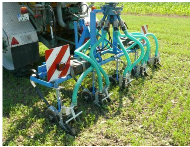
Ausbringung in Bestand mit Scheibenschlitzgerät
