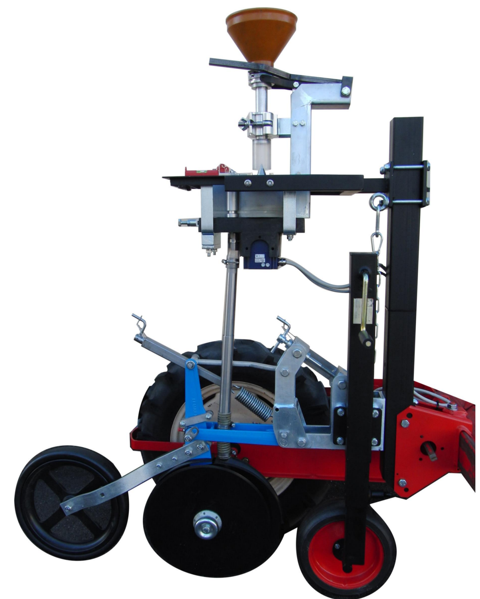
Das neuentwickelte Säaggregat für Heil- und Gewürzpflanzen der LfL
