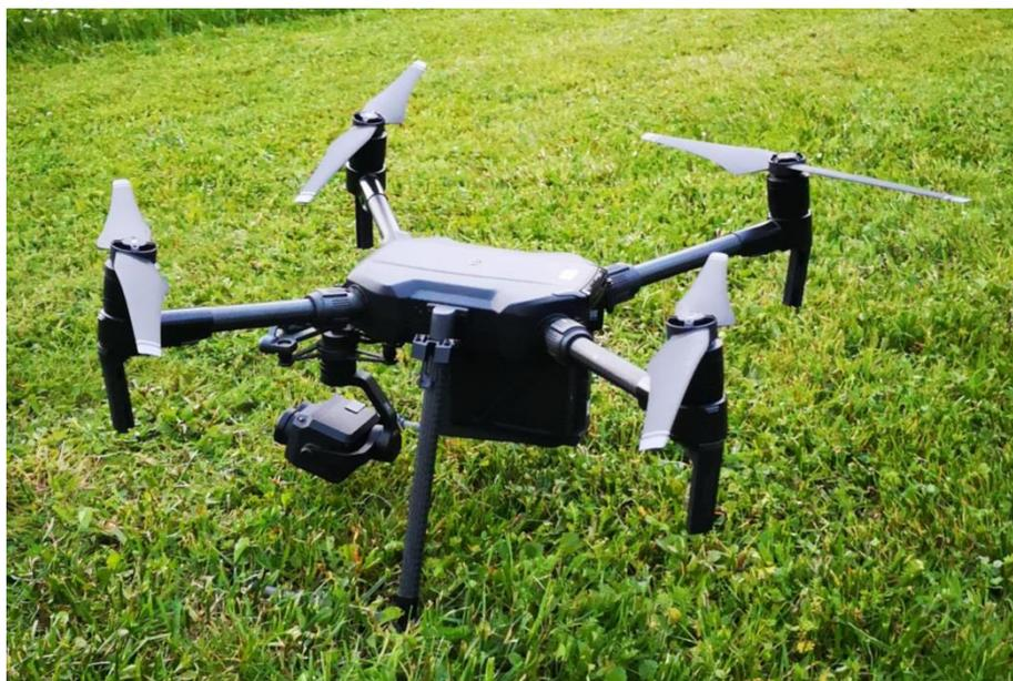
Abbildung 10: DJI Matrice 200 Drohne mit CGO ET Wärmebildkamera (Bildquelle: S. Thurner, 2019)
