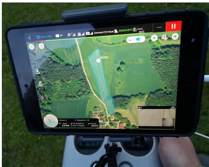
Abbildung 11: Software DJI Ground Station Pro bei der Flugplanung am i-pad (Bildquelle: S. Thurner, 2019)
