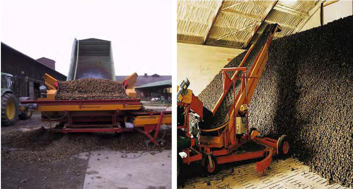
**Abbildung 37:** Links Sturzbunker mit Sortier- und Reinigungseinheit. Rechts automatischer Boxenfüller in der Kartoffelhalle.
