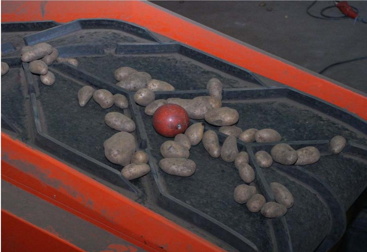
**Abbildung 46:** Knolle IS 100, wie sie von der KTBL Versuchsstation Dethlingen eingesetzt wird
