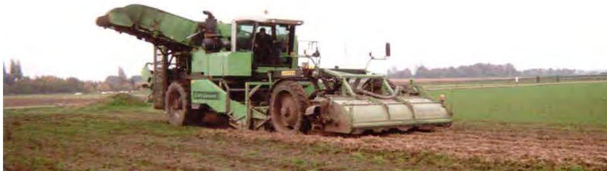
**Abbildung 11:** 4-reihiger SF Überlader/Bunkerroder (Solanum) mit Zwischenbunker (3,5 t) von Netagco AVR
