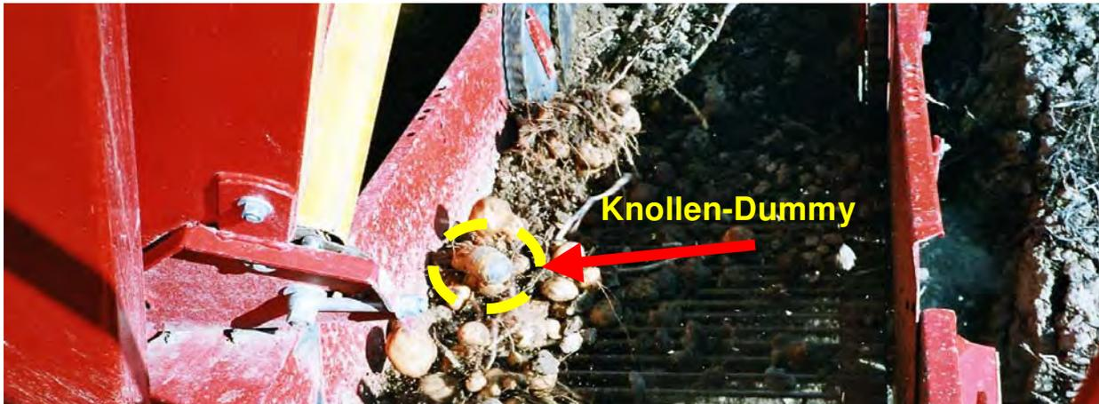
**Abbildung 54:** Die elektronische Knolle nach der Dammaufnahme im Gutstrom auf der Siebkette
