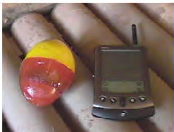
**Abbildung 48:** Der „Smart Spud Pro“ mit dem Palm als Handheld Computer
