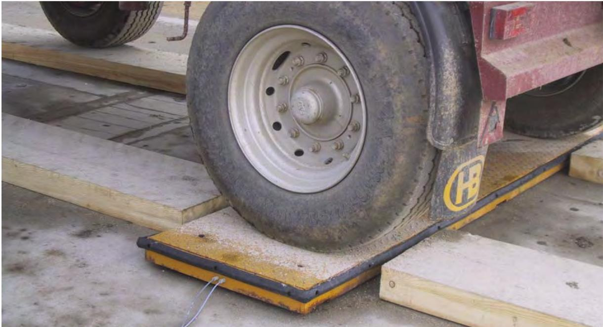
**Abbildung 24:** Achslastwaage während der Überfahrt. Durch das dynamische Wiegen entstand kaum Zeitverlust.
