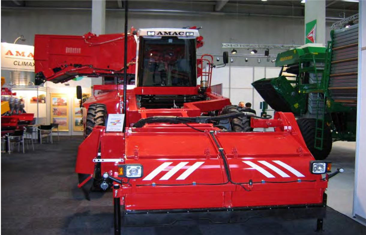
**Abbildung 9:** 2-reihiger SF Bunkerroder der Firma Dunor
