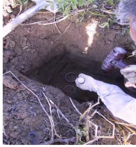
**Abbildung 39:** Einschlagen der Stechzylinder
