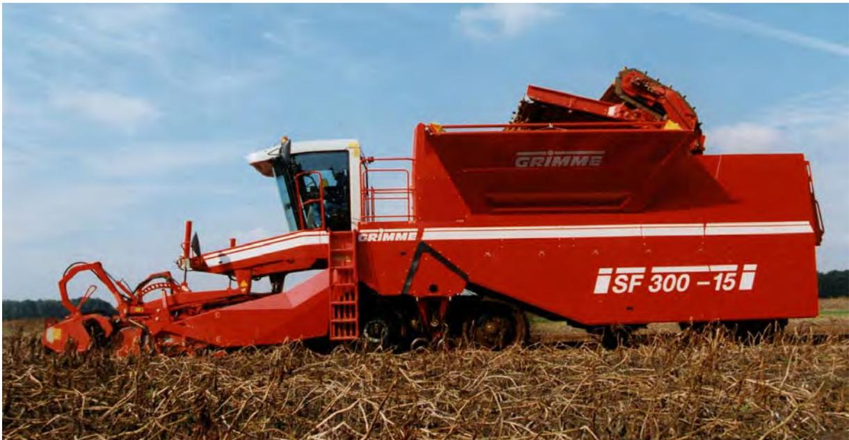
**Abbildung 13:** Der 4-r SF „Tectron“ Bunkerroder der Firma Grimme mit 15 t Bunkervolumen
