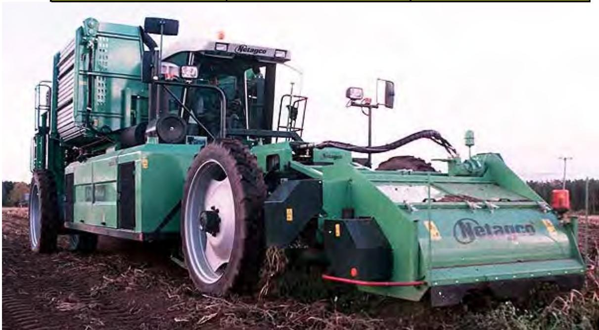
**Abbildung 7:** 2-r SF Mistral Bunkerroder der Firma Netagco
