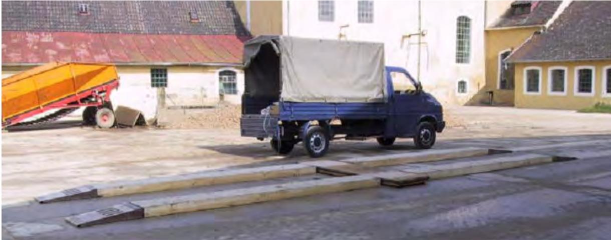
**Abbildung 23:** Mobile Achslastwaage mit Überfahrrampe.
