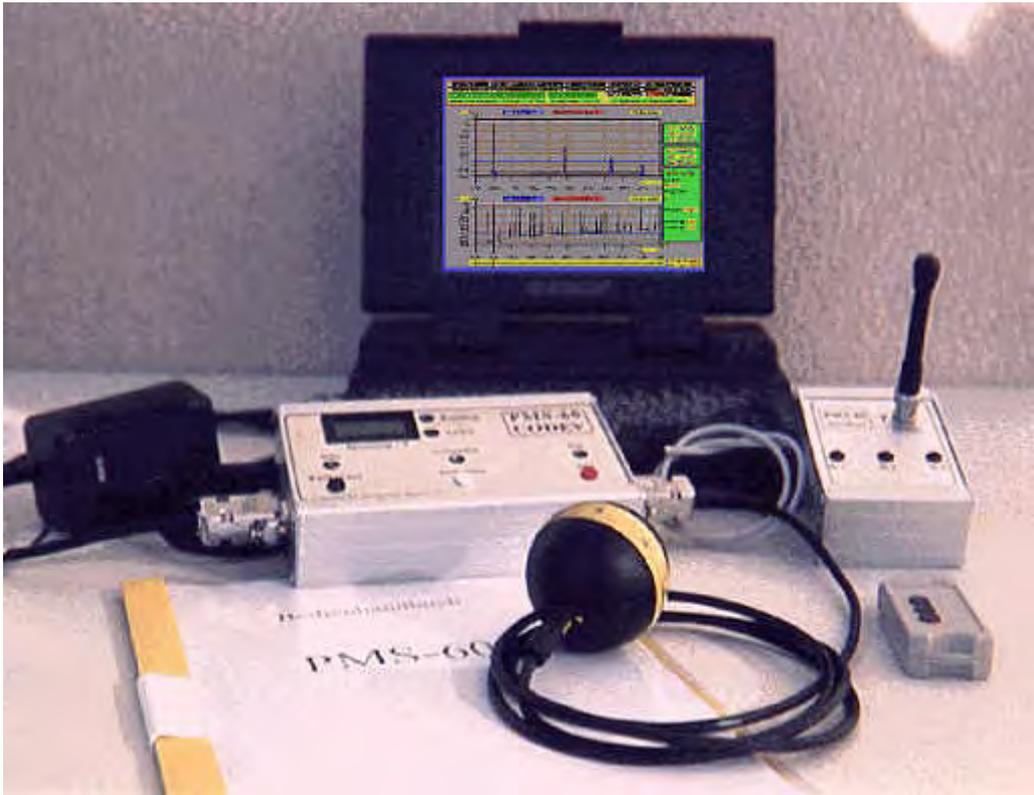
**Abbildung 45:** „Elektronische Knolle“ PMS-60 entwickelte Knolle
