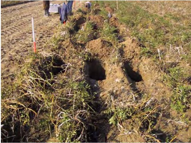
**Abbildung 38:** Löcher zwischen den Kartoffelfeldämmen zur Stechzylindermessung
