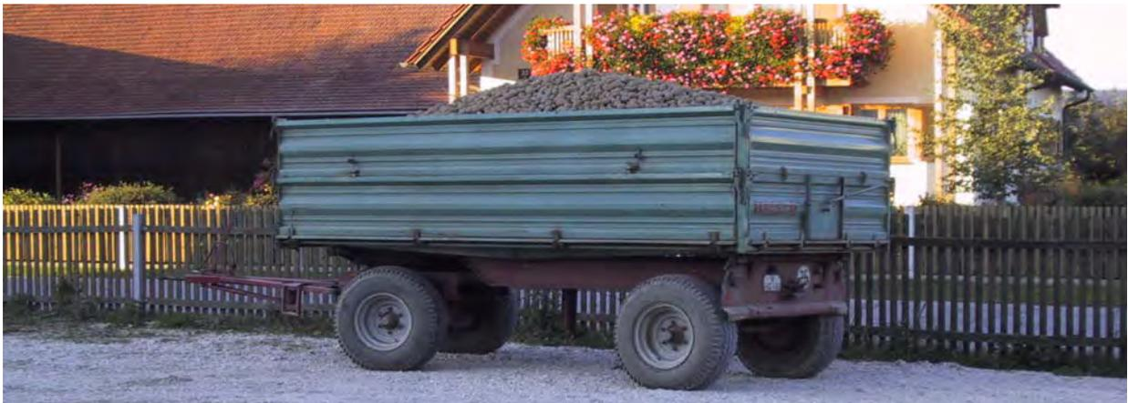
**Abbildung 35:** 2-Achsskipper mit einem zulässigen Gesamtgewicht von 16 t
