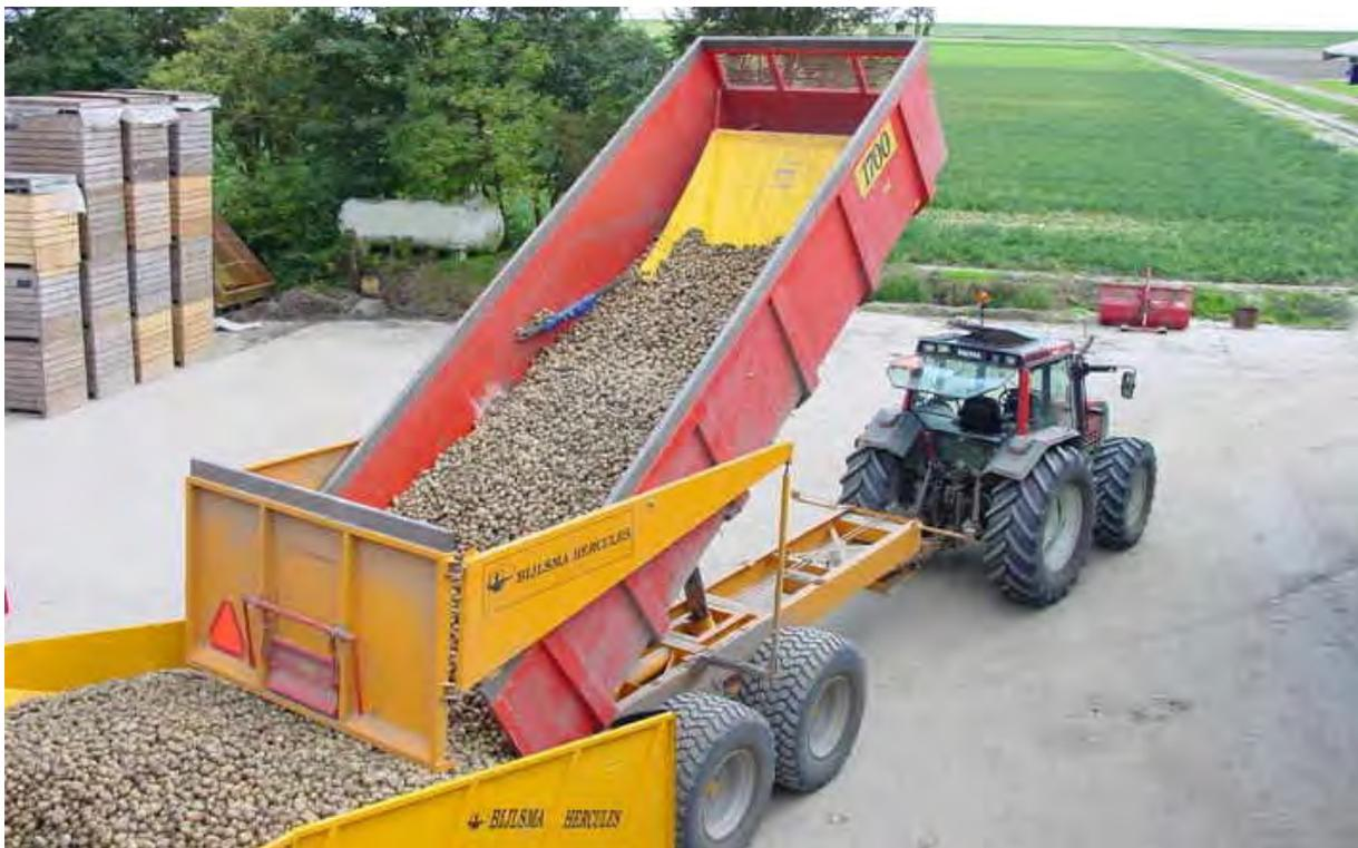
**Abbildung 34:** Muldenkipper mit einer Nutzlast von 16 t beim Rückwärtskippen in einen Sturzbunker
