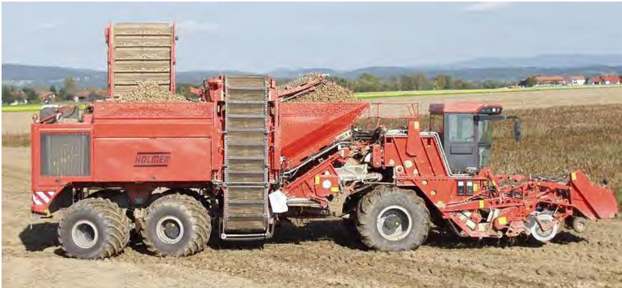
**Abbildung 12:** Der „Terra Melix“ von der Firma Holmer mit 16 t Bunkervolumen
