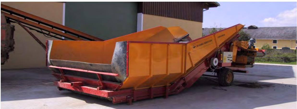
**Abbildung 36:** Sturzbunker zur Einlagerung von Kartoffeln (Leistung: 60 t/h)
