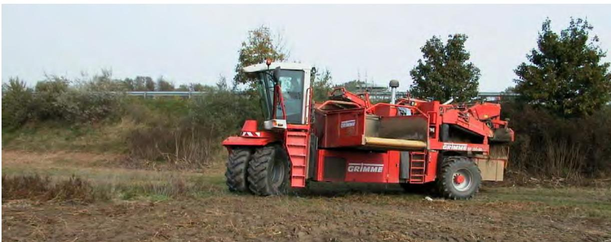
**Abbildung 60:** Zweireihiger Selbstfahrer mit 6 t Bunkerfassungsvermögen (Grimme SF 150-60)
