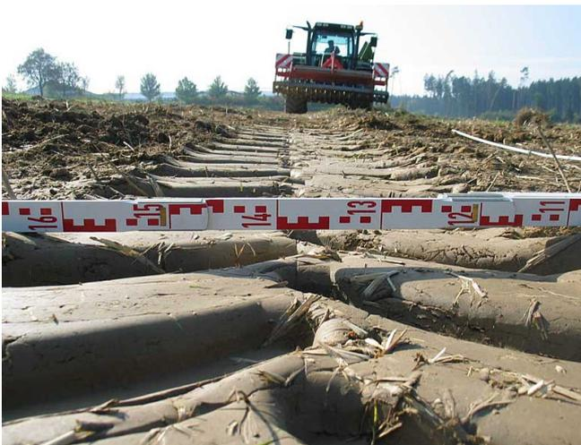
Bild 2: Verformungen beim Befahren eines Lehmbodens in kritisch feuchtem Zustand (© LfL, Bild: ILT1a)
