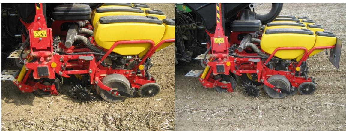
*Abb. 5: Strohräumer und Standardandruckrollen (links) bzw. Standardandruckrolle + Curvetine (rechts)*
