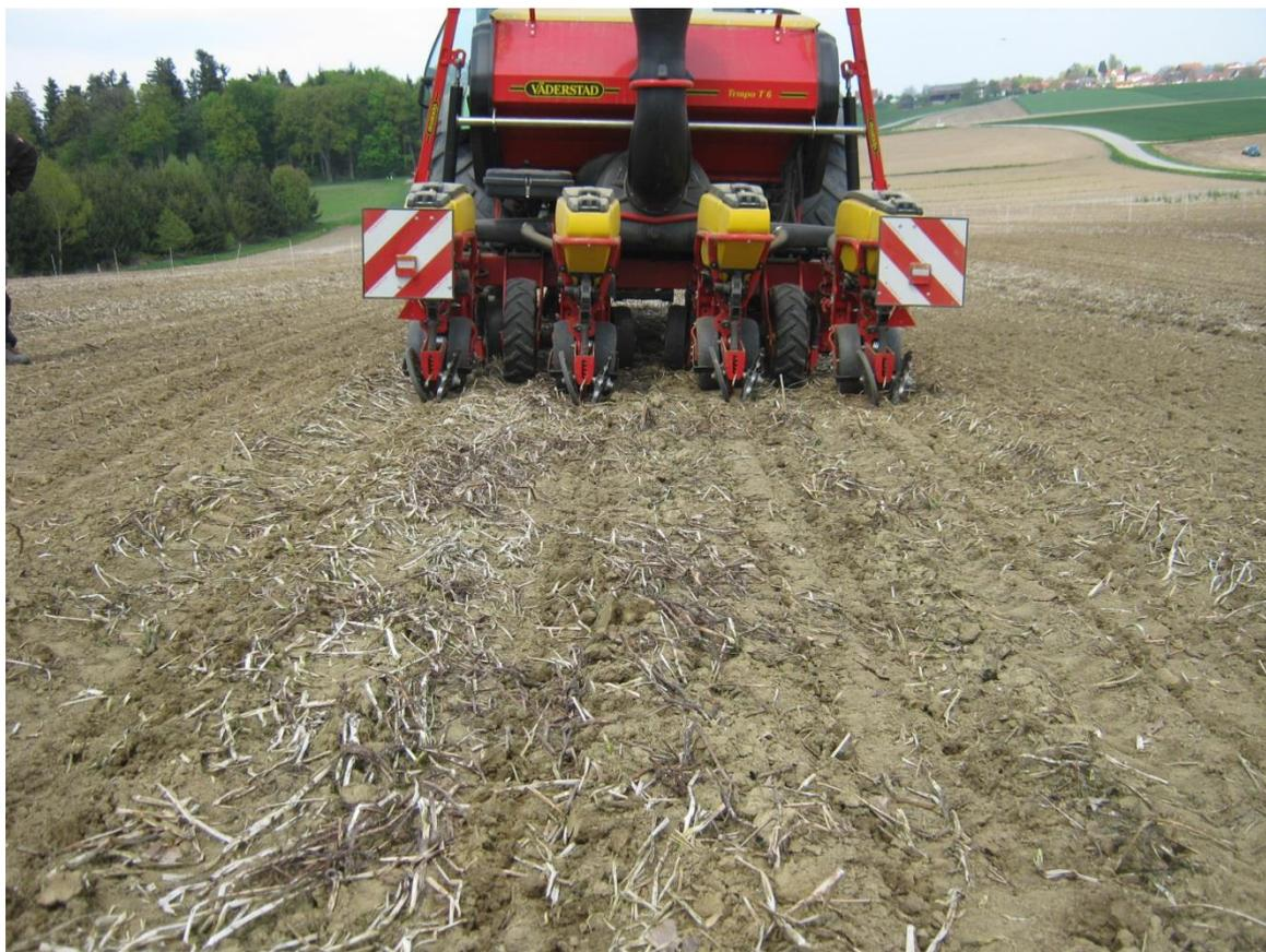
*Abb. 17: Im Mulch abgelegtes Saatgut (Schneidscheibe/keine Strohräumer)*
