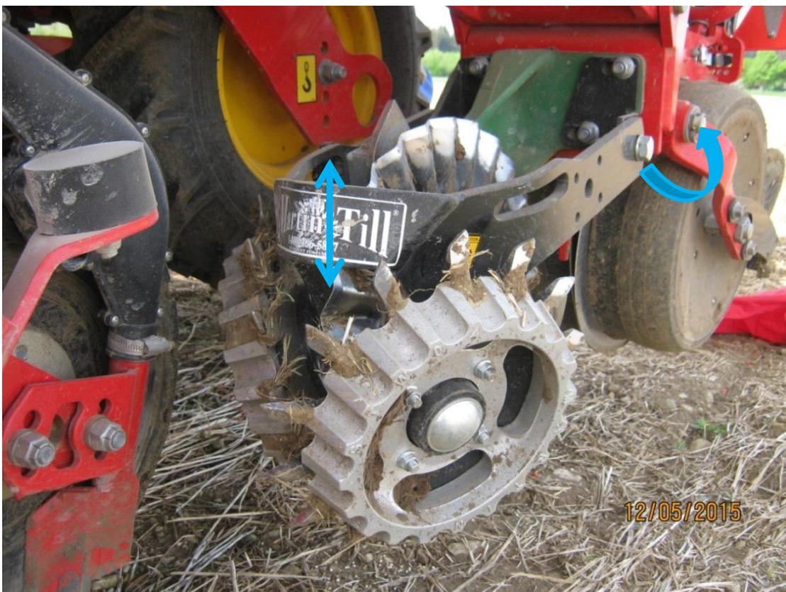
Abb. 15: Frei bewegliche/schwimmende Strohräumer (Martin Till)
