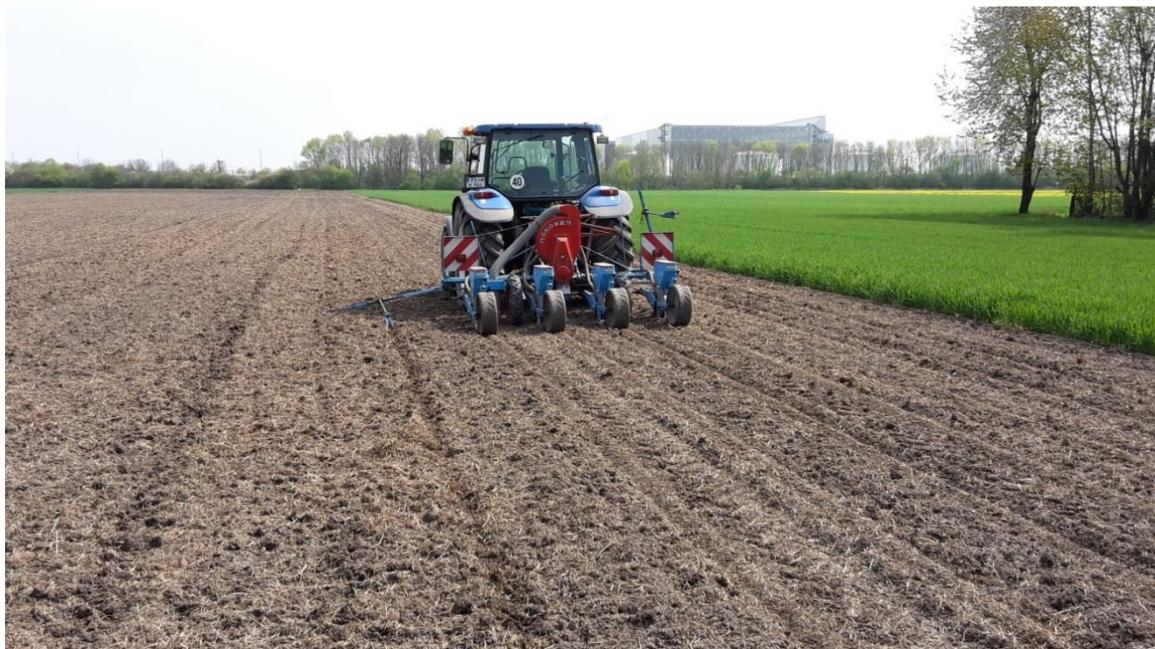
Abb. 1: Einzelkornsäugerät mit Säbelschar (Mulchsaat >30% Bodenbedeckung)
