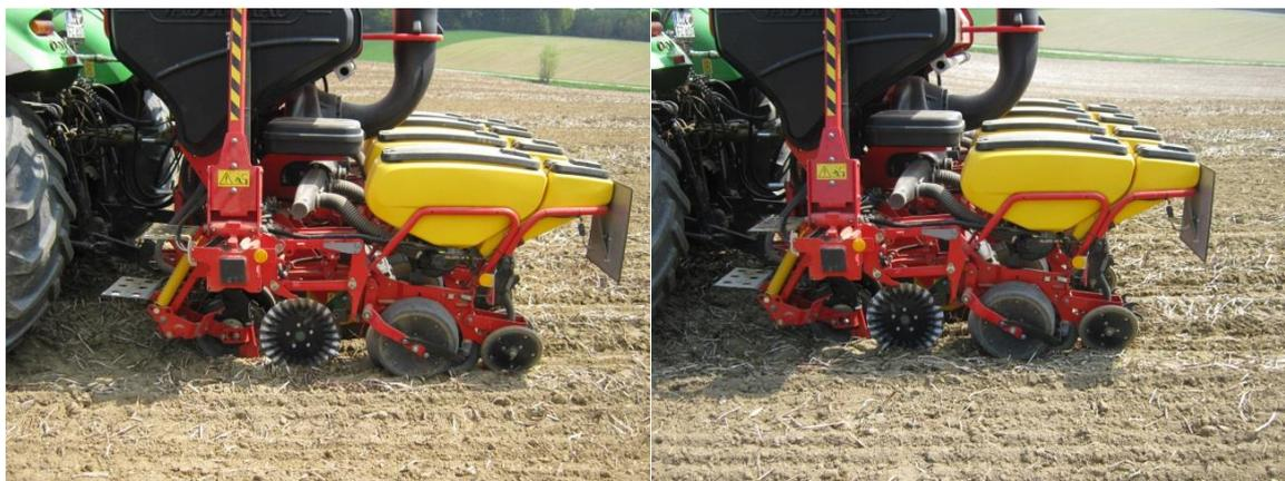
Abb. 6: Schneidscheibe und Standardandruckrollen (links) bzw. Standardandruckrolle + Curvetine (rechts)
