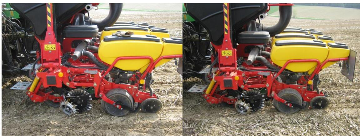
Abb. 7: Schneidscheibe + Strohräumer mit Standardandruckrollen (links) bzw. Standardandruckrolle + Curvetine (rechts)
