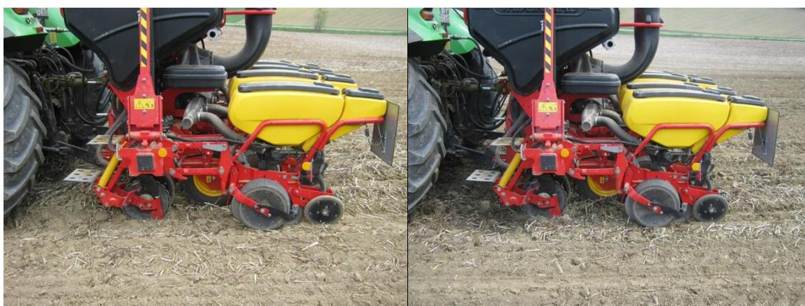
*Abb. 4: Keine Vorwerkzeuge mit Standardandruckrollen (links) bzw. Standardandruckrolle + Curvetine (rechts)*
