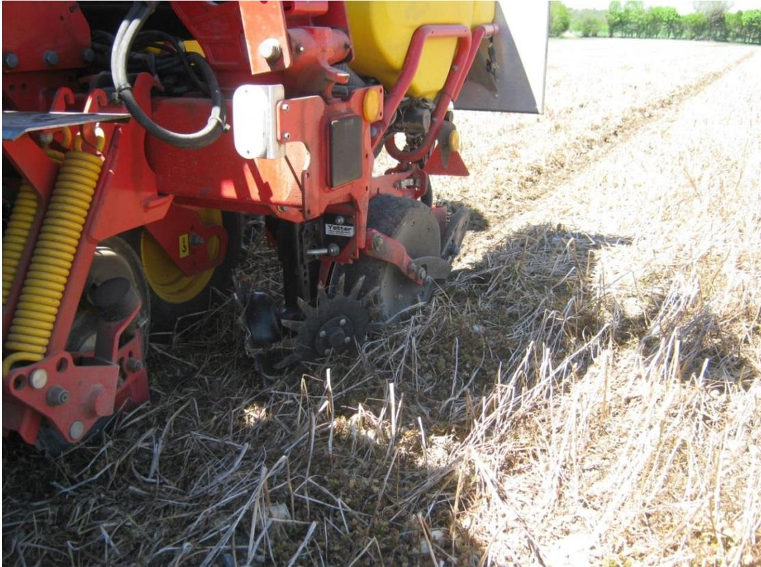
*Abb. 13: Fix montierte Strohräumer (Yetter)*
