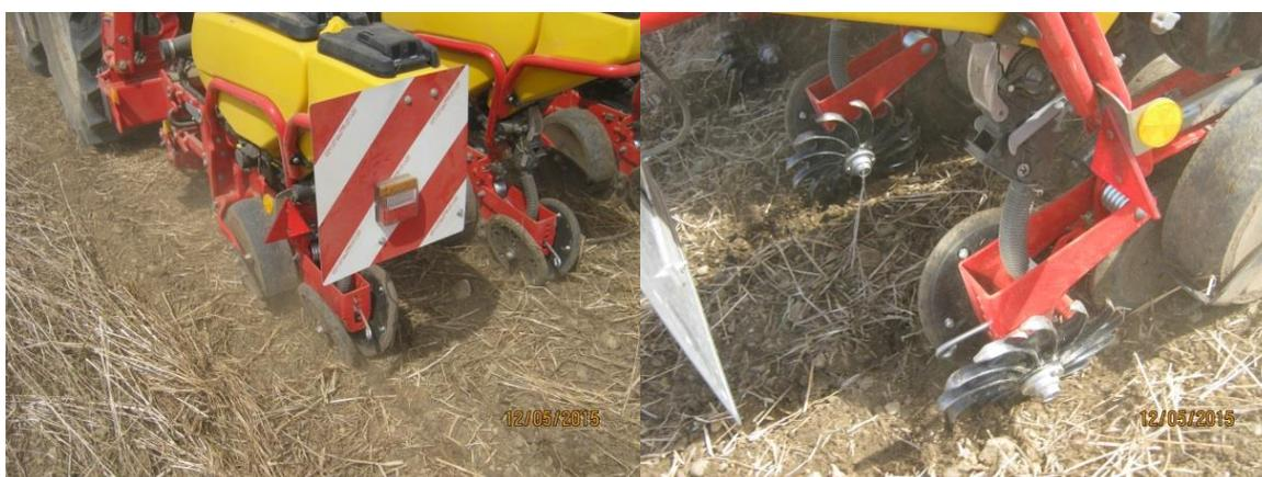
Abb. 3: V förmige Andruckrollen „standard“ (links) und „strukturiert“ (rechts)
