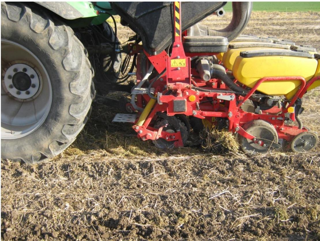
Abb. 14: Strohräumer mit anhaftendem Stroh Boden Gemisch
