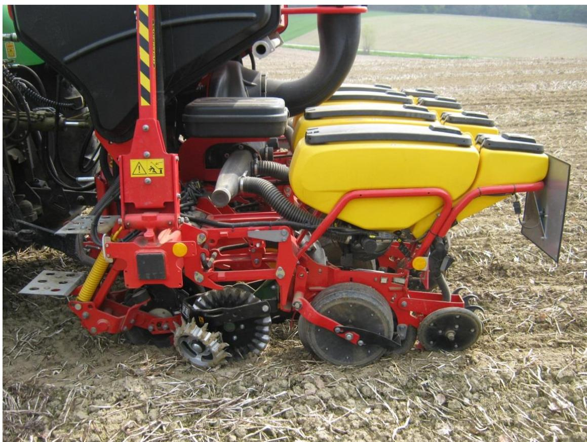
*Abb. 2: Maissägerät mit allen verfügbaren Zusatzwerkzeugen*
