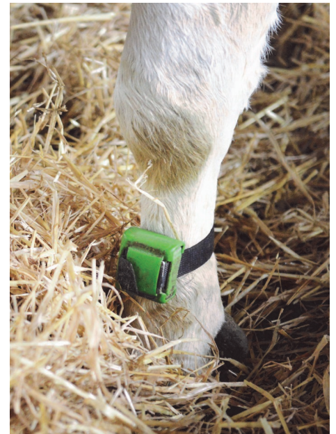
Abb. 1: Erfassung von Schritten, Fress- und Liegeverhalten mit Pedometer
