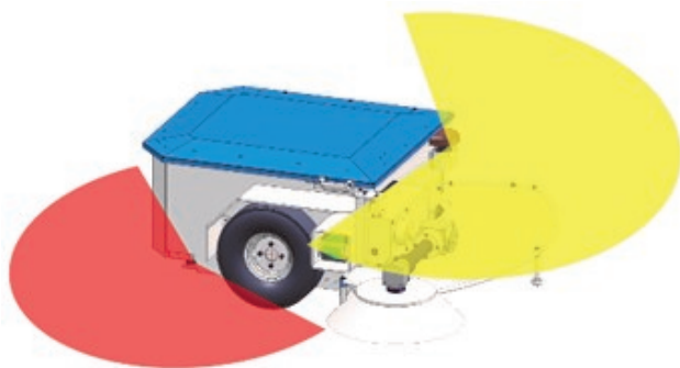
Sichtfeld und Anbringung der beiden Laserscanner
