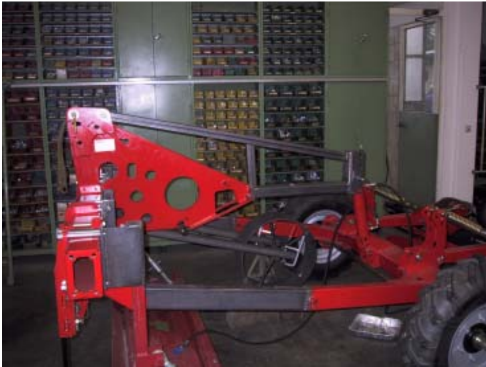
Abbildung 26: Rahmenverlängerung im vorderen Bereich
