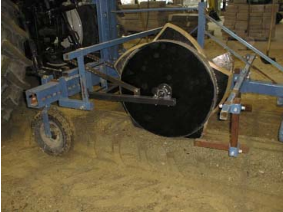
Abbildung 8: Pflanzrad aus Betoplanplatten und Stahl
