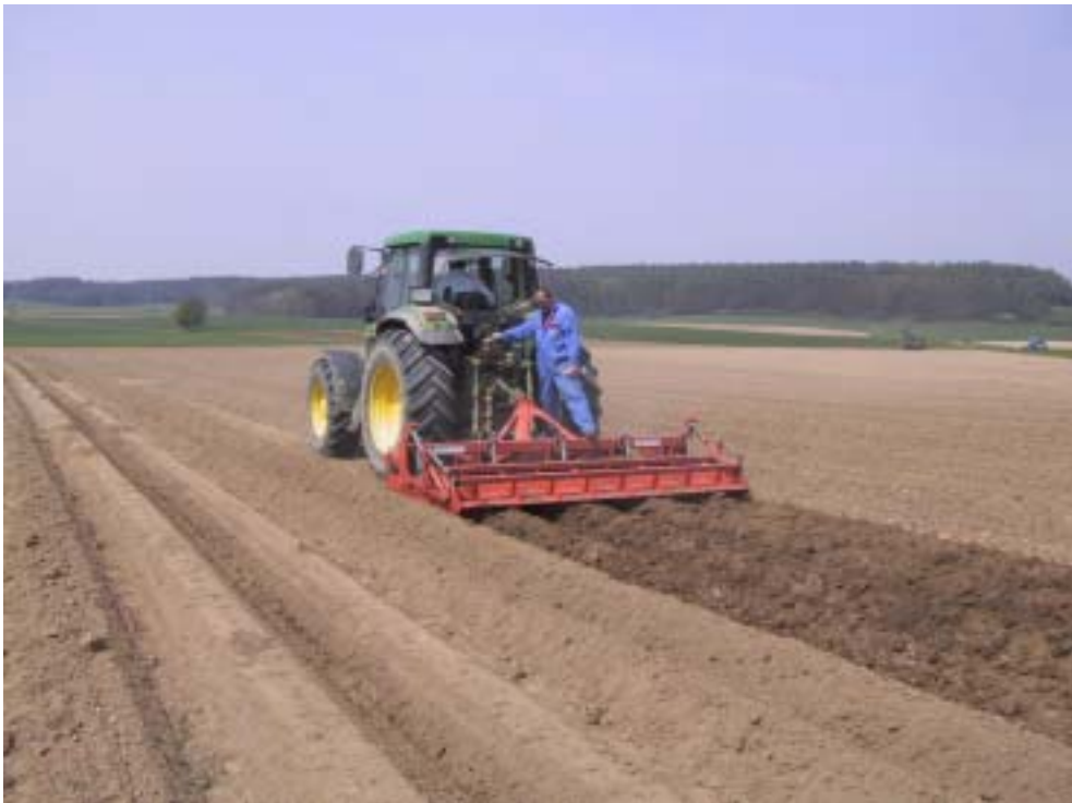
Abbildung 10: 4 Reihiger Dammformer im Einsatz
