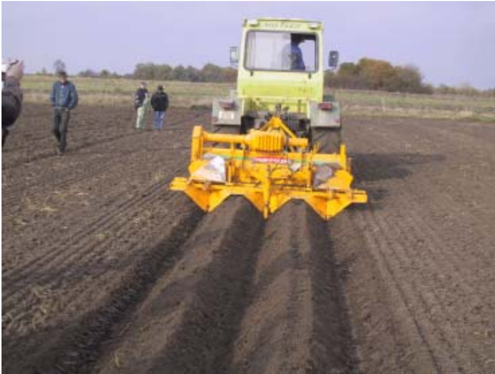
Abbildung 9: 2 Reihige Dammfräse zur Dammformung
