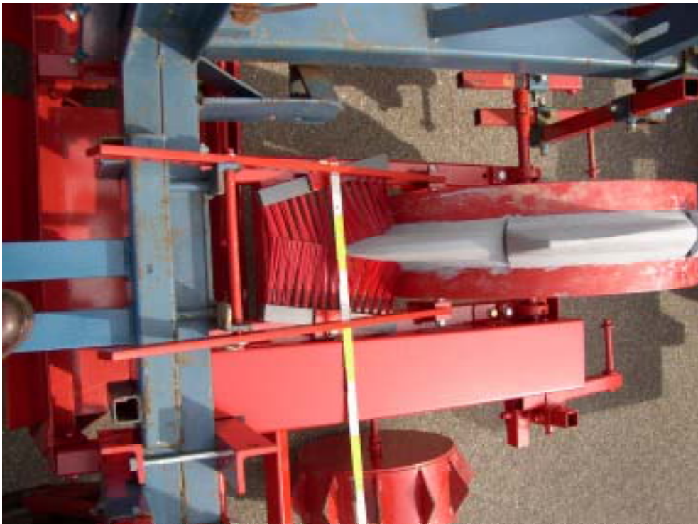
Abbildung 20: Bürstenabstreifer am linken Pflanzrad
