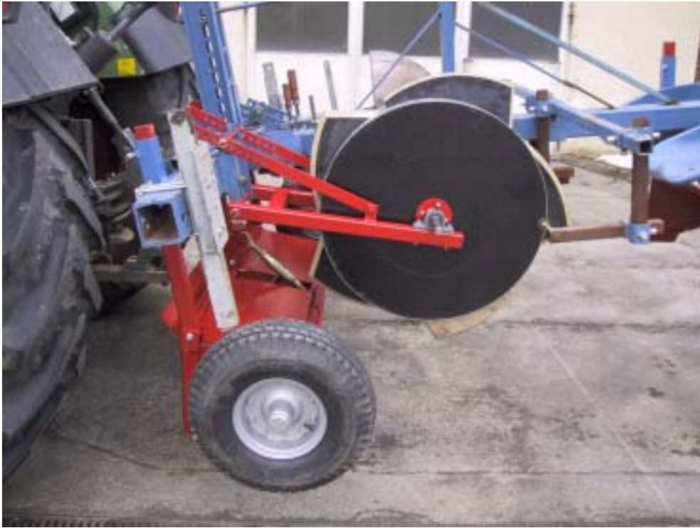
Abbildung 11: Vorderer Dammformer zur Führung der Maschine
