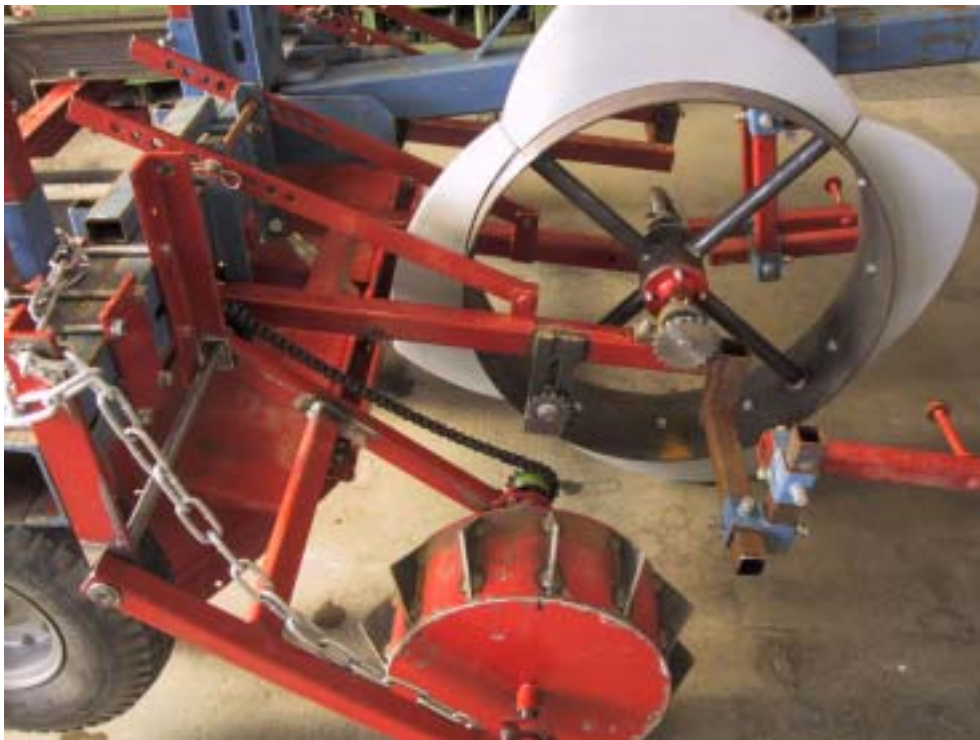
Abbildung 16: Neues Pflanzrad und Zwangsantrieb
