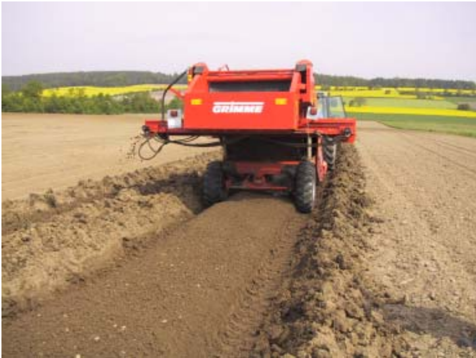
Abbildung 31: Beetseparierung im Feldversuch
