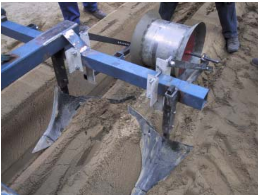
Abbildung 12: Häufelkörper zum Verschließen des Pflanzloches
