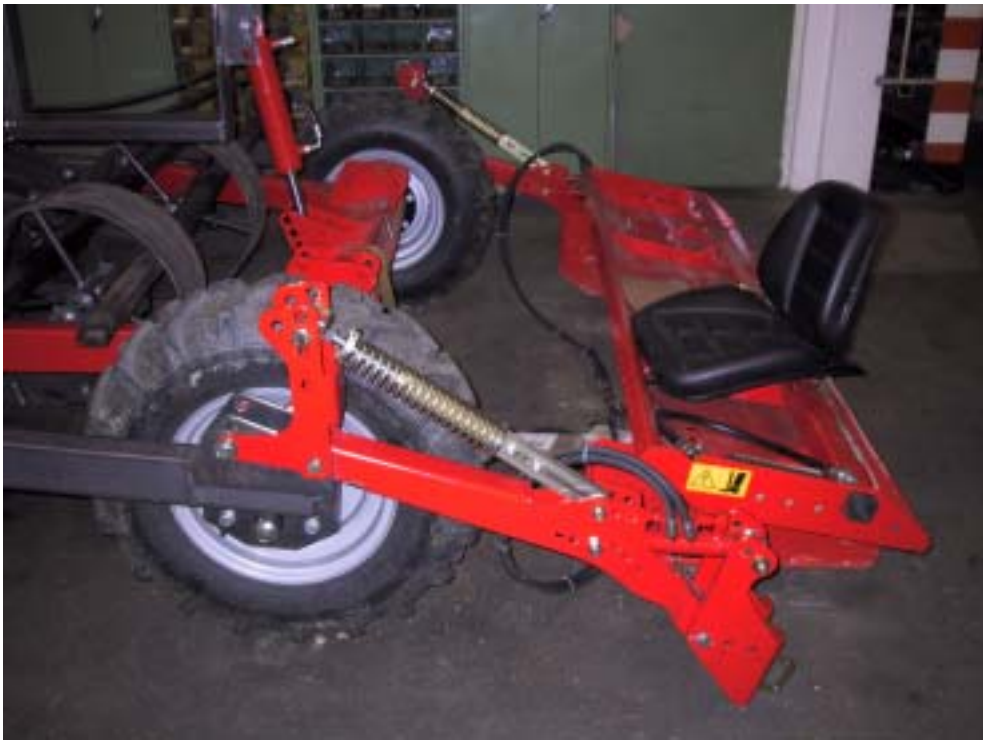
Abbildung 27: Umbau Halterung hinterer Dammformer
